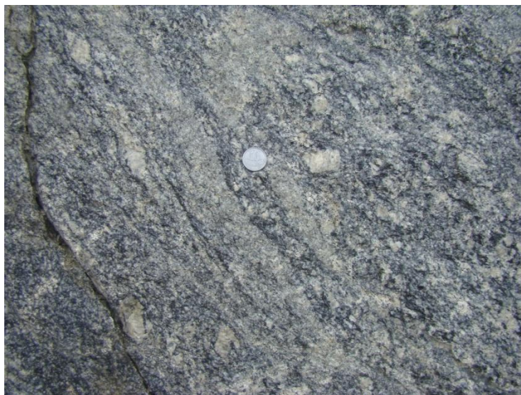
Figura 15. Fenocristais de K-feldspato orientados e estirados (ponto PMB-03a).
