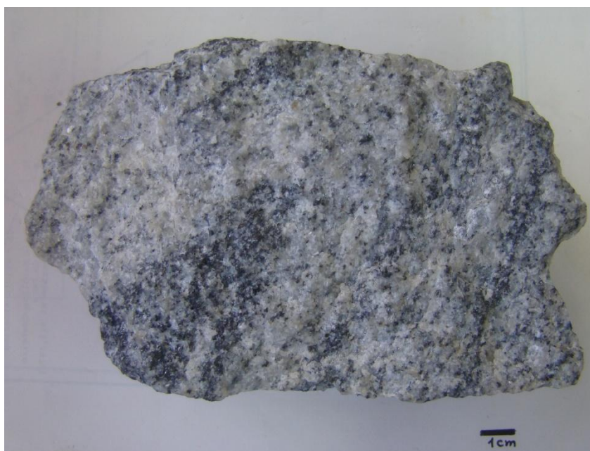
Figura 32. Amostra de mão do biotita monzogranito (PMB-03A) com schlieren de biotita.
