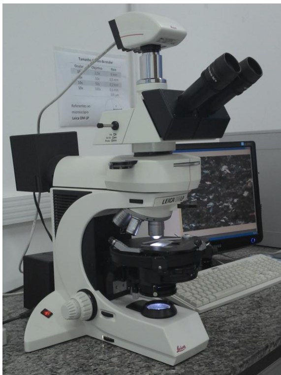
Figura 9. Microscópio óptico utilizado na descrição das lâminas petrográficas, modelo Leica ME-LP .
