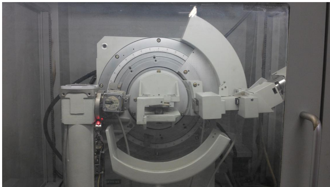
Figura 11. Difratorômetro utilizado para as análises do projeto, modelo SIEMENS – D 5000
