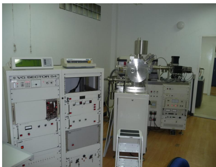
Figura 13. Espectrômetro de massa TIMS modelo VG-54 do Laboratório de Geologia Isotópica do Instituto de Geociências da UFRGS.
