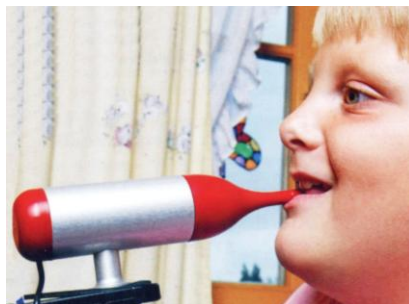
Figura 16. Exemplo do mouse controlado pelo movimento da boca
