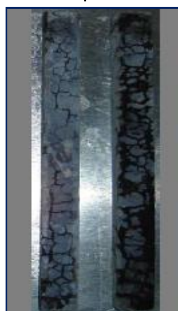
Figura – Barras de argamassa confeccionadas com 25 % de CCA moída após ensaio de expansão, aos 30 dias.
