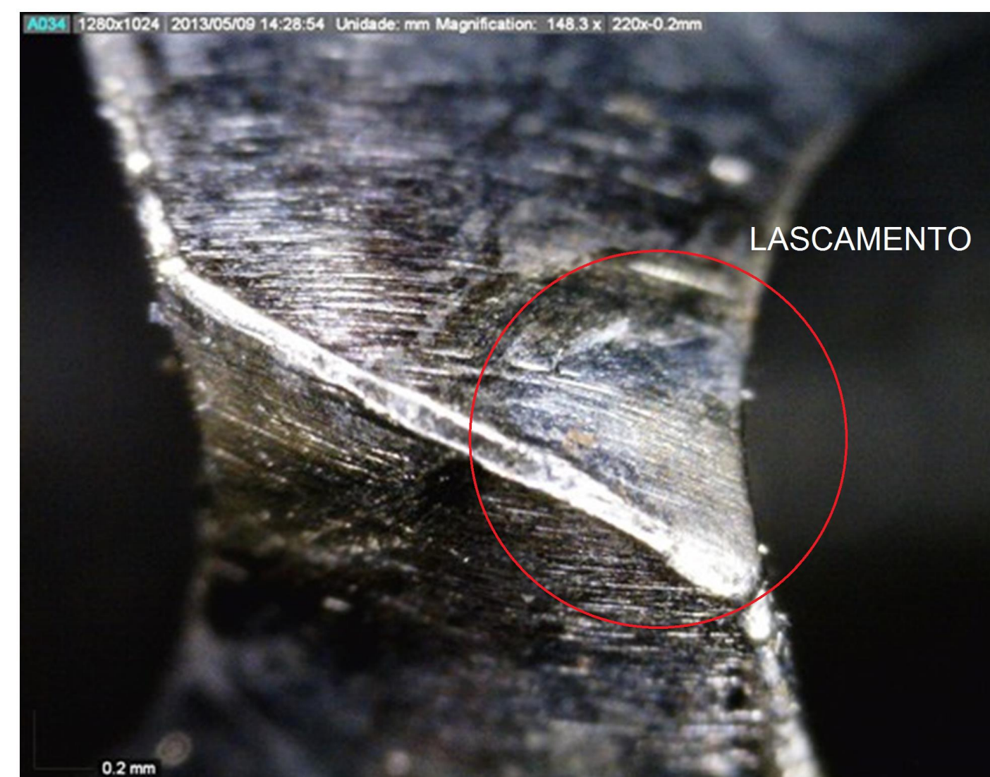
Figura 3: Foto da ponta da broca após o 103° furo (ampliação de 148,3x).
