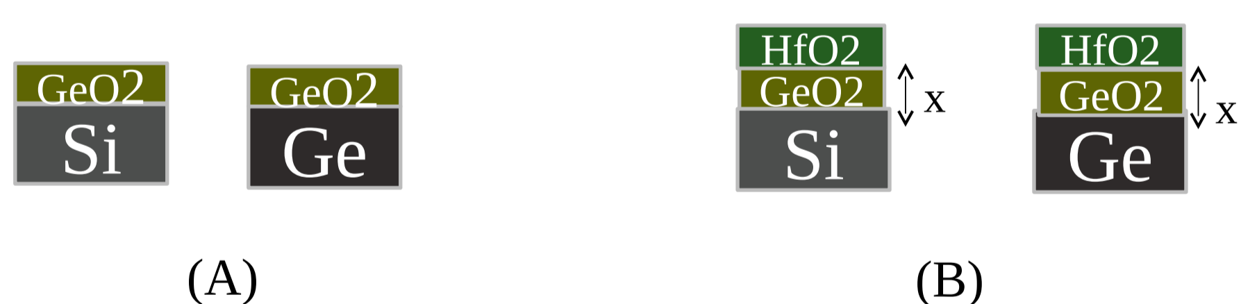
Figura 1 – Esquemas de estruturas óxido-semicondutor formado. (A) Representação do GeO 2 depositado sobre silício e crescido termicamente germânio. (B) Estrutura com filme de Ge O 2 interfacial com espessuras de 5, 10 e 20 nm, sobre a qual foi depositada por sputtering um filme de 2 nm de HfO 2 .
