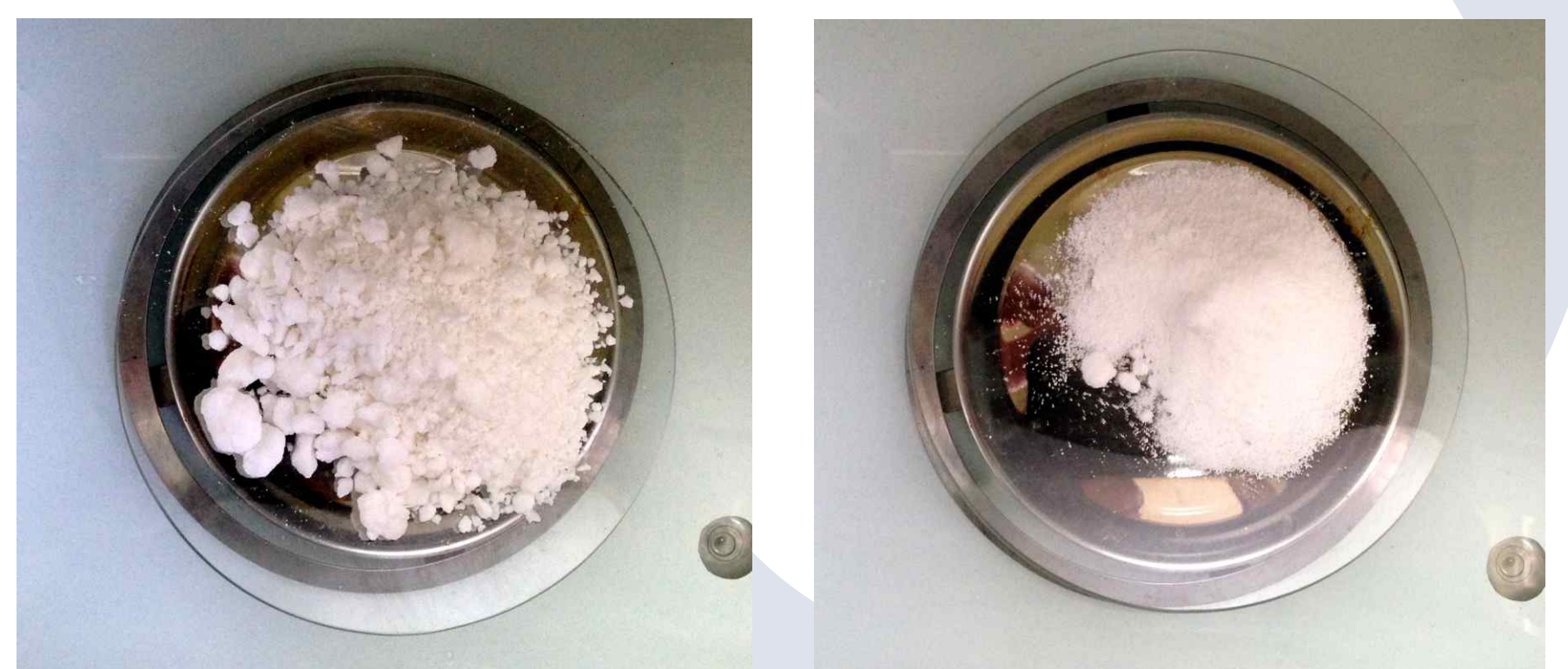
Microcápsulas de parafina (método antigo) antes e após peneiração. À esquerda, está a parte inutilizável da produção; à direita, parte aproveitável, 30%.
