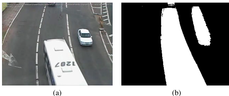
Figura 4.8: Exemplo de máscara binária obtida através do método MEI. (a) quadro original; (b) máscara binária gerada.
