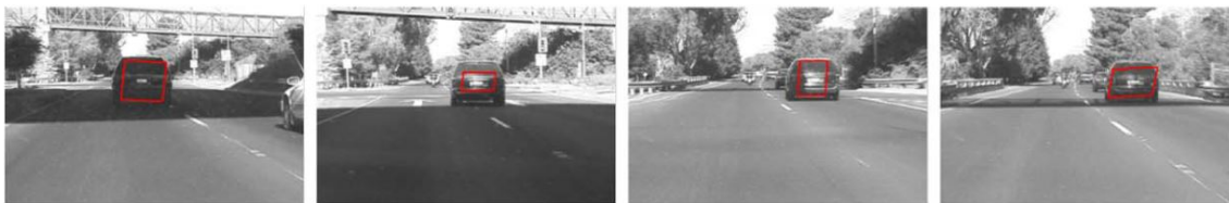
Figura 2.10: Exemplo de rastreamento utilizando o método proposto por Mei e Ling (2011).
