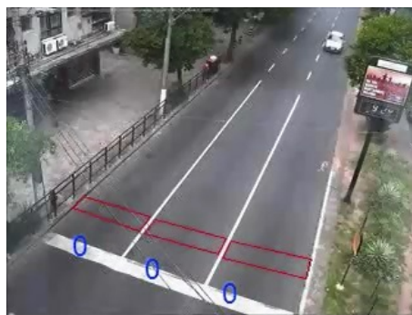
Figura 4.3: Exemplos de laços virtuais. Cada laço virtual é posicionado em uma das faixas da via, juntamente com seus respectivos contadores
