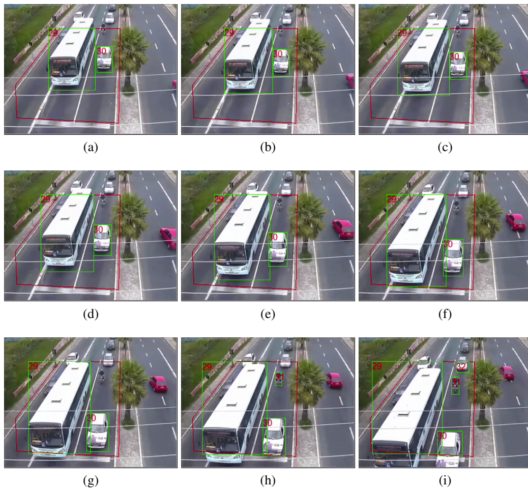
Figura 5.13: Exemplo oclusões na Cam64. (a) - (i) ilustram o rastreamento de veículos na Cam64 em uma situação onde ocorrem problemas de oclusão de veículos. Devido à posição da câmera, os veículos da primeira pista sofrem oclusões quando veículos maiores, como ônibus, estão na pista central.
