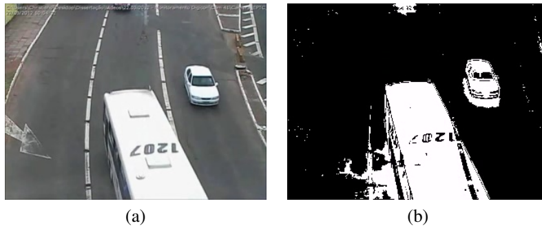
Figura 4.7: Exemplo de máscara binária obtida através do método GMM. (a) quadro original; (b) máscara binária gerada.
