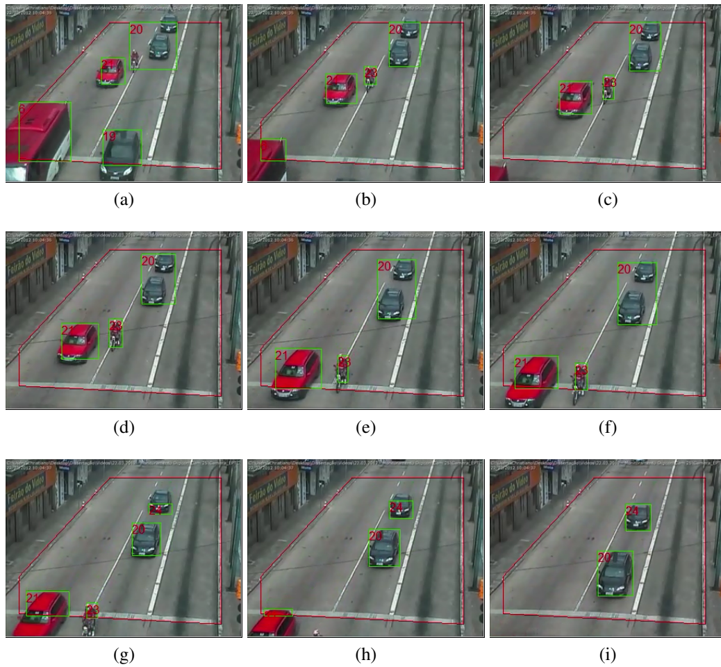
Figura 5.5: Exemplo de rastreamento na Cam25. (a) - (i) ilustram o rastreamento de veículos em uma sequência de quadros da Cam25.
