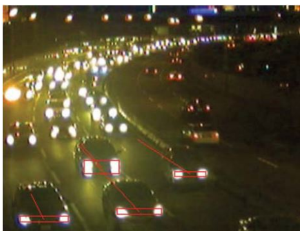
Figura 2.15: Exemplo de veículos sendo rastreados em uma sequência de imagens noturnas com o método proposto por Chen et al. (2011).
