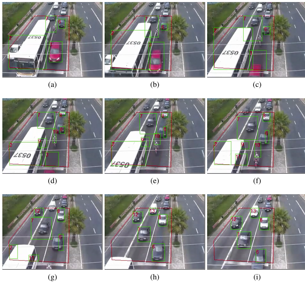
Figura 5.12: Exemplo de falha de detecção na Cam64. (a) - (i) ilustram o rastreamento de veículos na Cam64 em uma situação onde ocorrem problemas de detecção dos veículos. O problema ocorre devido aos veículos estarem parados no início do vídeo, o que faz com que a máscara de foreground fique fragmentada, voltando ao normal conforme os veículos se movem.
