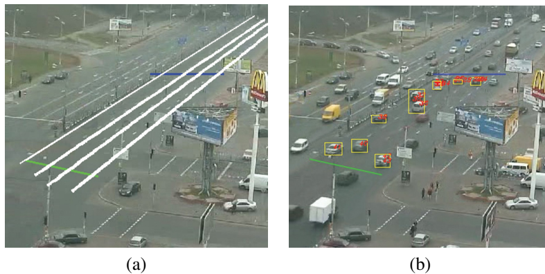
Figura 2.13: Exemplo do método proposto por Sanchez et al.. (a) imagem utilizada como modelo de fundo, com as regiões de entrada (linha verde), saída (linha azul) e as quatro linhas delimitando as faixas da pista (em branco); (b) exemplo de rastreamento (SANCHEZ et al., 2011).
