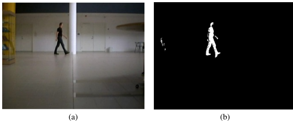
Figura 2.3: Exemplo de subtração de fundo usando a mediana. (a) um quadro do vídeo original; (b) objeto do primeiro plano detectado usando a mediana para o cálculo do fundo (JOUBERT, 2009).
