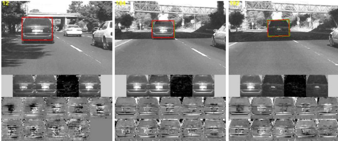
Figura 2.8: Exemplo de rastreamento do método proposto por Ross et al. em uma sequência de quadros, onde a primeira linha exibe o objeto rastreado, a segunda linha exibe o centro do subespaço, a imagem rastreada, o resíduo e a imagem reconstruída usando as eigenbasis , respectivamente. A terceira linha exibe as imagens da eigenbasis do subespaço atual (ROSS et al., 2007).
