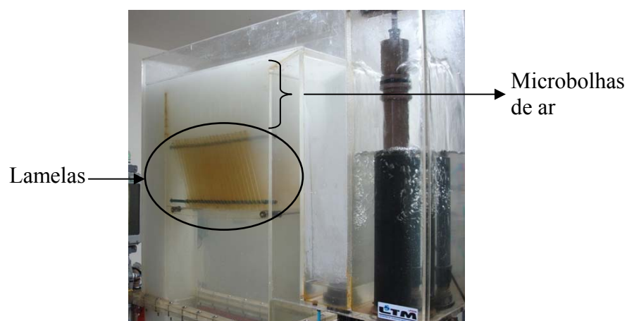
Figura 29. Detalhe da nuvem de microbolhas de ar acima das lamelas no FADAT (Flotador por ar dissolvido de alta taxa).
