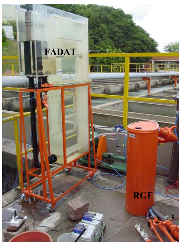
Figura 30. Aplicação do RGF para clarificação da água de uma planta de tratamento por flotação.
