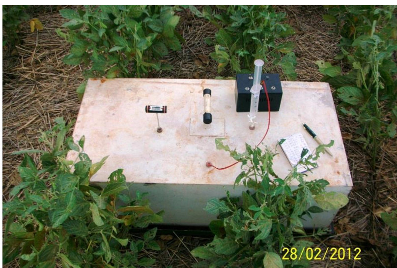
FIGURA 5. Câmara para coleta de GEE do solo.
