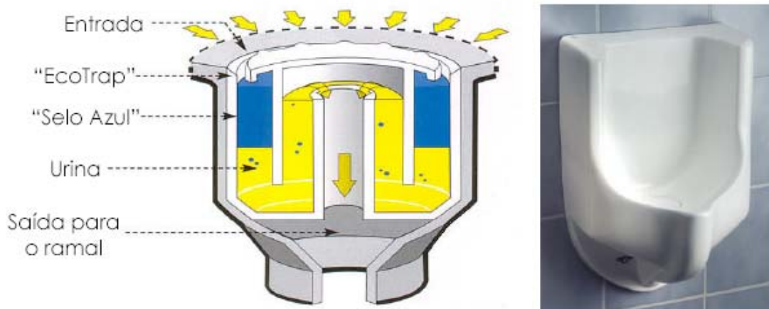
Figura 21: mictório sem consumo de água, esquema do fecho hídrico e vista do aparelho (SCHERER, 2003)
