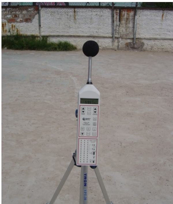
Figura 53: medidor de nível de pressão sonora utilizado nas medições.
