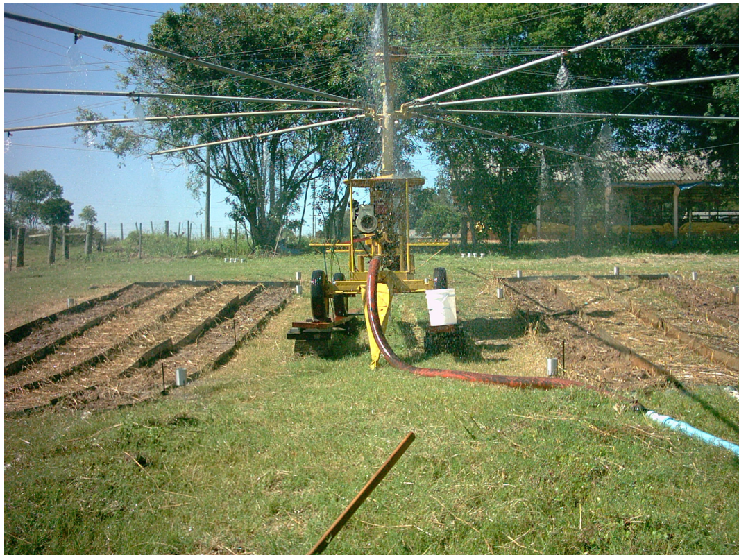
FIGURA 2. Vista de um bloco experimental, com o simulador de chuvas posicionado entre as parcelas, possibilitando a aplicação simultânea da chuva em todos os tratamentos de um mesmo bloco.
