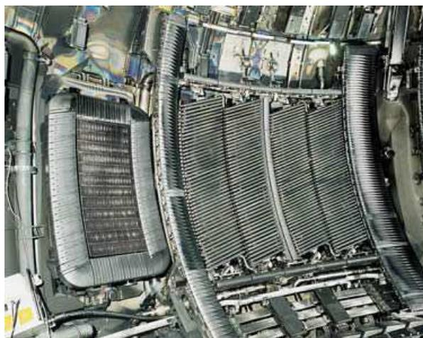
Figura 14: Antenas LHCD e ICRH no JET. O "grill" LHCD está a esquerda próximo dos quatro lançadores de ICRH (MLYMAR, 2006).
