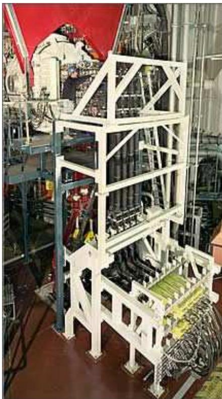
Figura 13: Conexão do sistema de guia de ondas do LHCD com vaso de vácuo do JET (MLYMAR, 2006).
