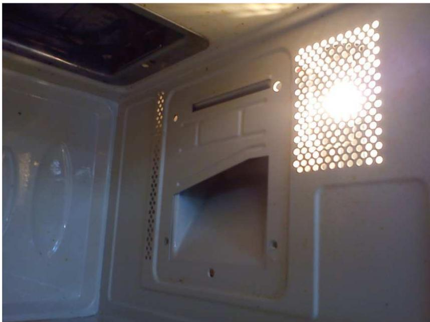
**Figura 7: Porta de micro-ondas de altura variável, refletor angulado e fresta; Guia de ondas e magnetron escondidos por parede metálica; Placa de mica removida**
