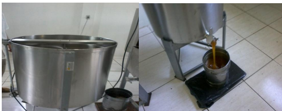
Figura 2: Centrífuga elétrica e mel sendo retirado para o tanque de decantação.
