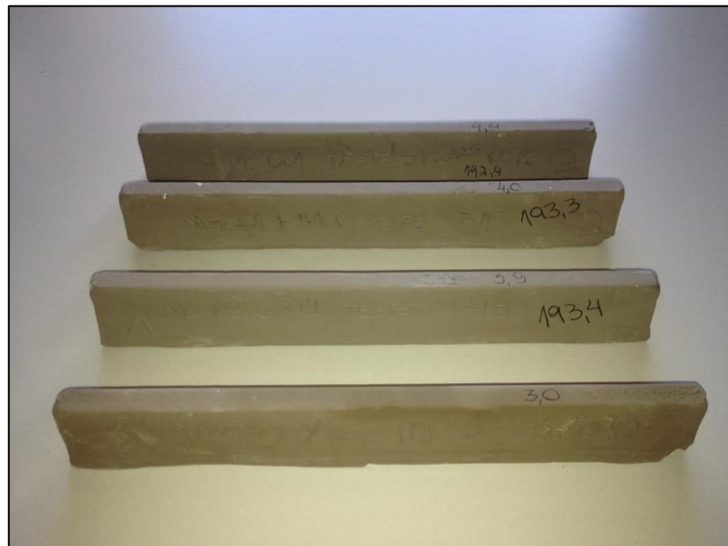
Figura 6.6 – corpos de prova obtidos para determinação da retração linear.
