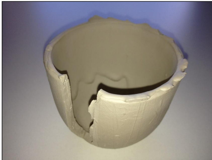
Figura 6.14 – corpo de prova obtido e cortado para medição da espessura de parede em molde de gesso
