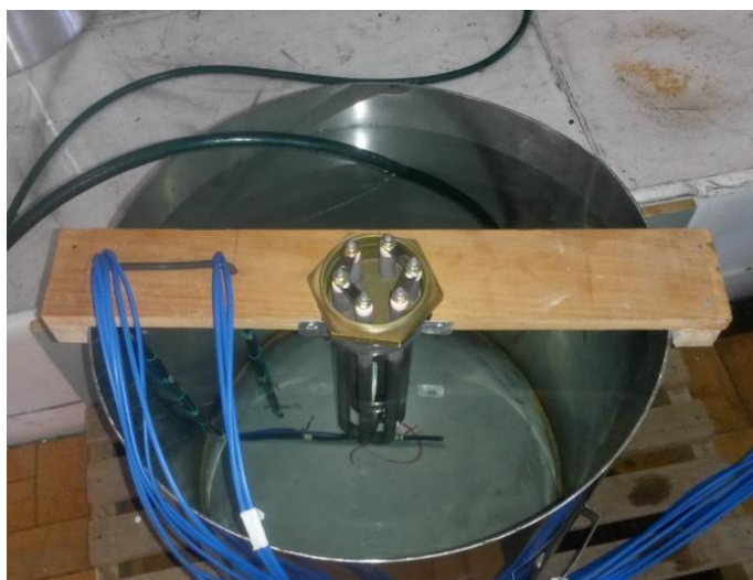
Figura 6.1: Armação de suporte da resistência e dos termopares
