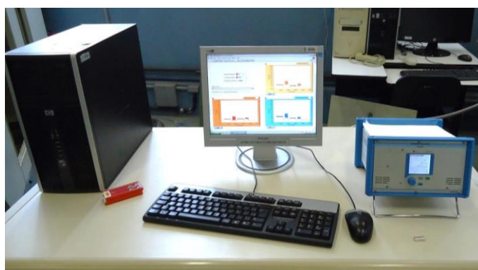
Figura 4.5 – Elementos constituintes do sistema de monitoramento de sinais de força.
