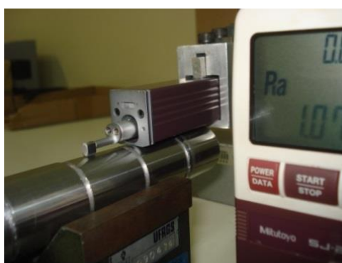
Figura 4.6 – Medição de rugosidade utilizando o rugosímetro SJ-201.
