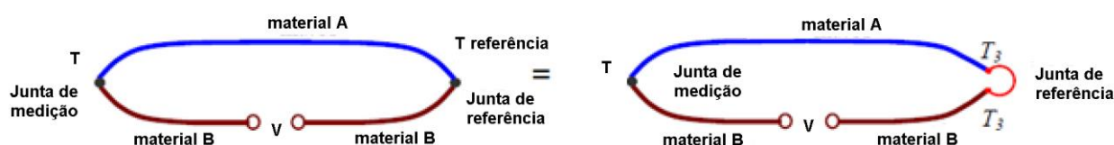
Figura 3.5 - Demonstração de que um terceiro metal no circuito termopar não interfere na medição.
