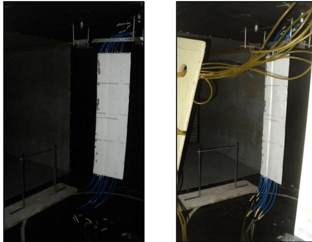
Fig. C1 – Esquema de fixação do perfil no túnel de vento e suporte para balança.
