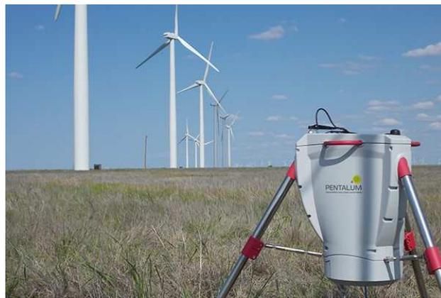
Figura 2.8 – Exemplo de Lidar [SECONDWIND, 2013].
