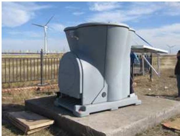
Figura 2.7 – Exemplo de Sodar [SECONDWIND, 2013].
