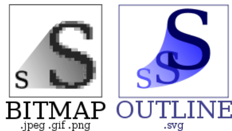
Figura 2.2: Exemplo de redimensionamento de imagem SVG
