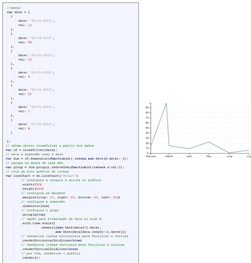
Figura 3.12: Exemplo de código para a renderização de um gráfico de linhas utilizando o dc.js
