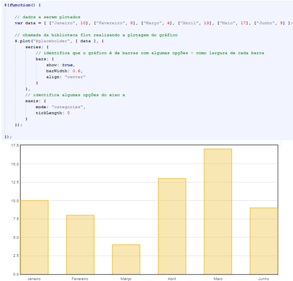
Figura 3.2: Gráfico em barras gerado pela API Flot (na parte inferior) e seu respectivo código (na parte superior)
