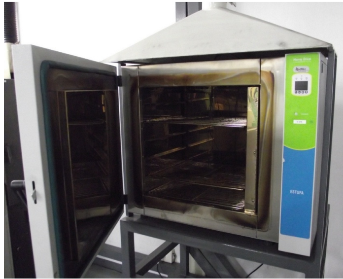
Figura 4.13 – Estufa utilizada para estabilização da temperatura dos corpos-de-prova.
