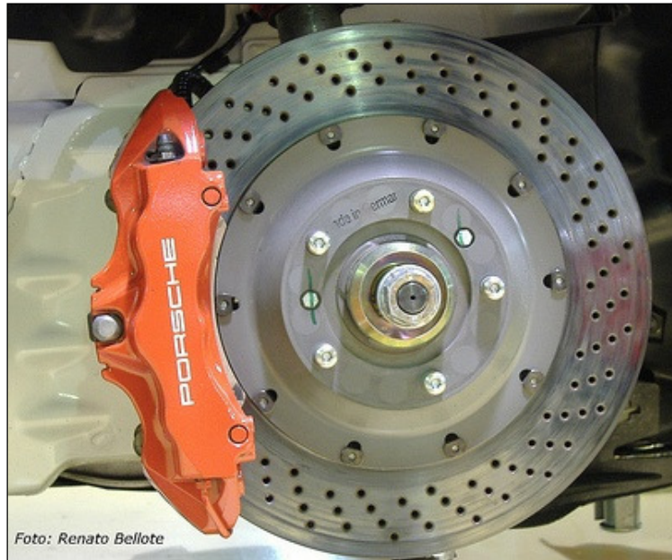
Figura 3.7 – Sistemas de freio disco/pastilha para veículo de passageiros [fonte: farm4.static.flickr.com].
