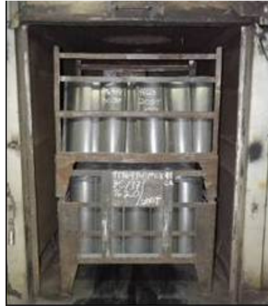
Figura 4.12 – Peças de material de fricção posicionadas no interior da estufa para realização do processo de tratamento térmico.
