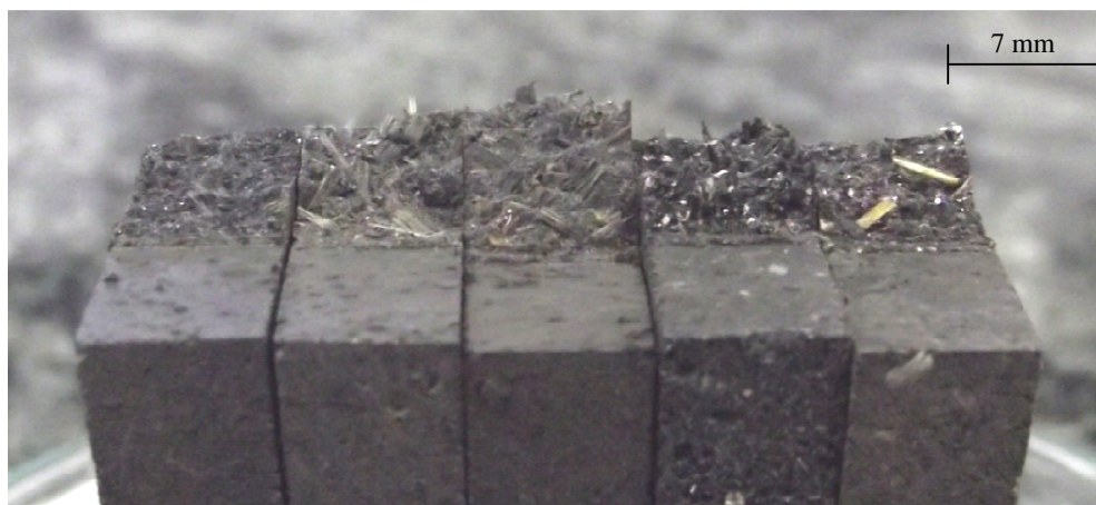
Figura 5.3 – Superfícies de fratura dos cinco materiais testados a 175°C. Da esquerda para direita, materiais A, B, C, D e E.
