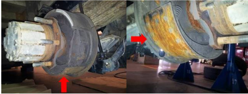
Figura 1.2 – Detalhes do freio de roda traseiro de um protótipo falhado que apresentou quebra seguida de desprendimento das lonas de freio na fase de validação em campo [fonte: Fras-le S.A.].
