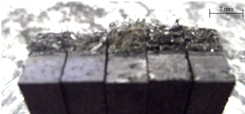
Figura 5.2 – Superfícies de fratura dos cinco materiais testados a 100°C. Da esquerda para direita, materiais A, B, C, D e E.
