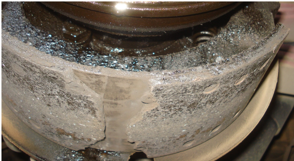
Figura 1.1 – Detalhe mostrando a ruptura parcial de componentes de fricção do freio de roda traseiro de um protótipo durante testes de homologação em veículo. [fonte: Fras-le S.A.].
