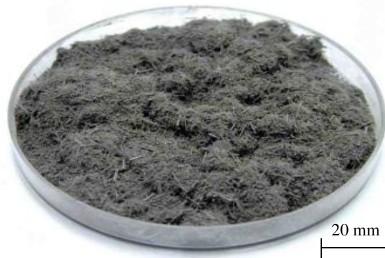
Figura 4.10 – Aspecto típico de uma composição de material de fricção após processo de homogeneização. Material B.
