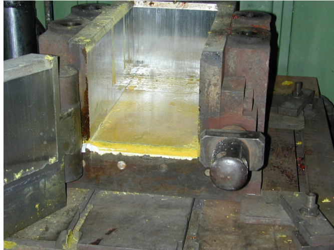
Figura 4.11 – Molde de compactação a quente tipicamente utilizado para moldagem de material de fricção.
