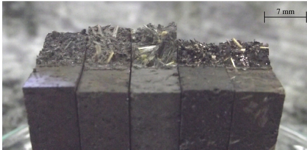
Figura 5.4 – Superfícies de fratura dos cinco materiais testados a 250°C. Da esquerda para direita, materiais A, B, C, D e E.
