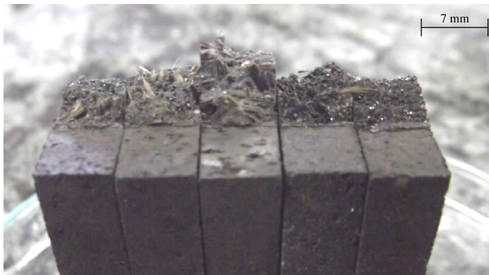
Figura 5.5 – Superfícies de fratura dos cinco materiais testados a 325°C. Da esquerda para direita, materiais A, B, C, D e E.
