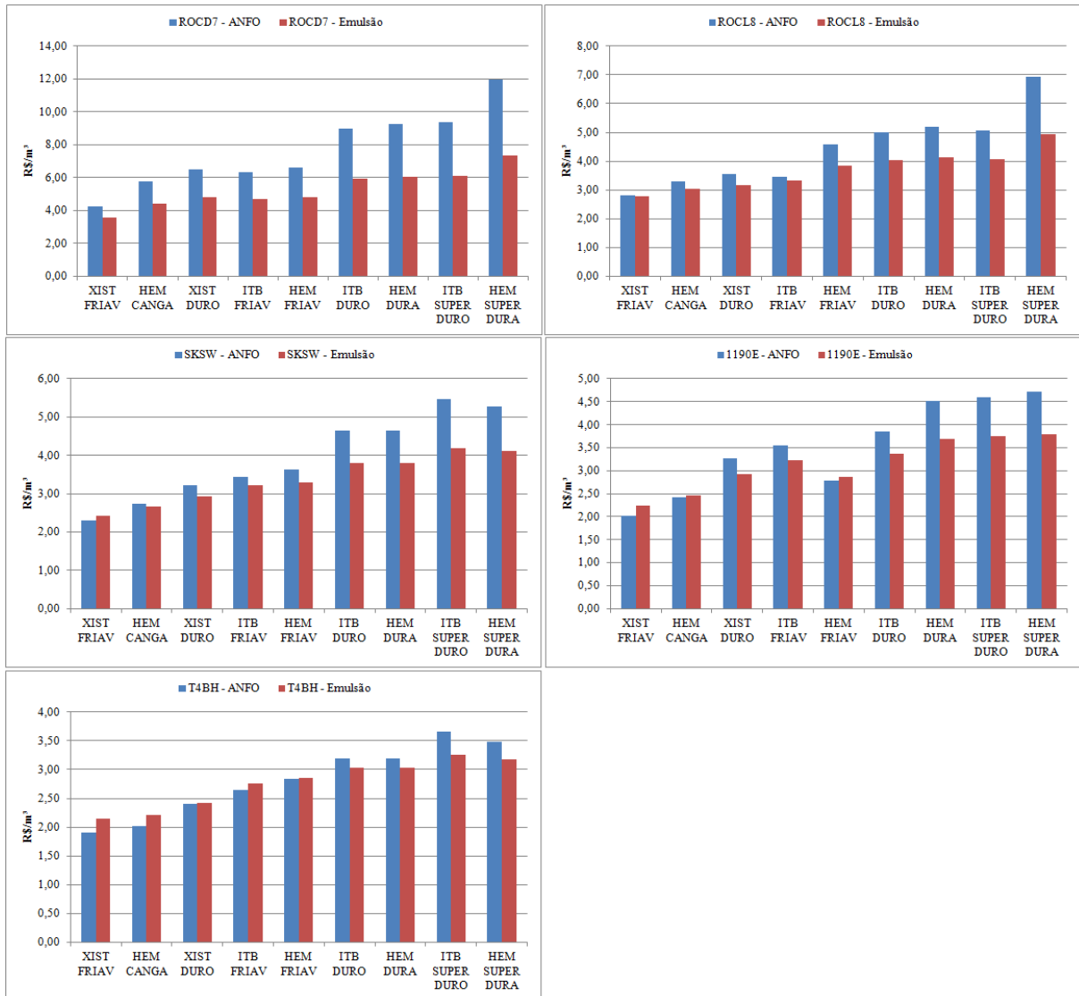
Figura 66 – Custo por m³ em função da litologia para cada frota, com ANFO e emulsão.
