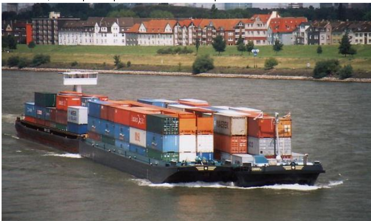
Figura 4.1 Comboio dotado de passadiço retrátil
