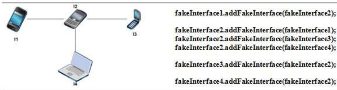
Figura 23 Exemplo de conexão de FakeInterfaces
