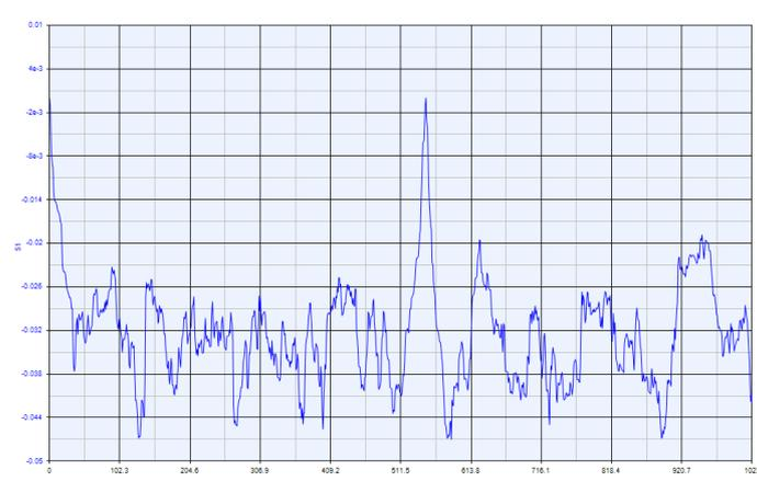
Figura 3.11: Função de autocorrelação do estimador de início de quadro OFDM
