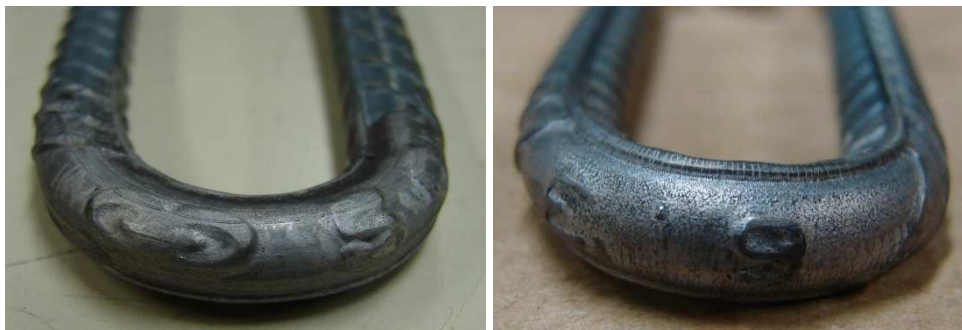
Figura 4.13 Resultados dos ensaios de dobramento a 180° nas amostras de vergalhão em rolo na bitola 6,3mm
