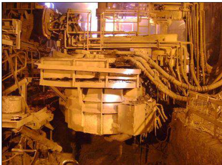
Figura 2.6 Forno elétrico a arco em operação Fonte: Cortesia de usina siderúrgica.
