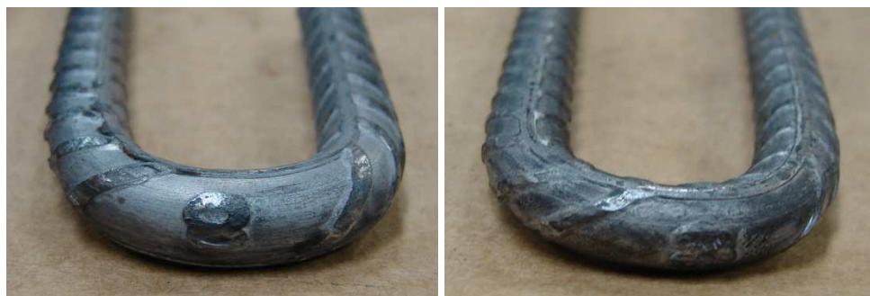
Figura 4.16 Amostras de vergalhão reto após ensaio de dobramento a 180° na bitola 8,0mm
