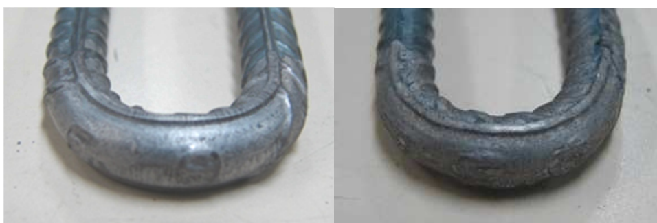
Figura 4.11 Amostras de vergalhão em rolo após ensaio de dobramento a 180° na bitola 6,3 mm
