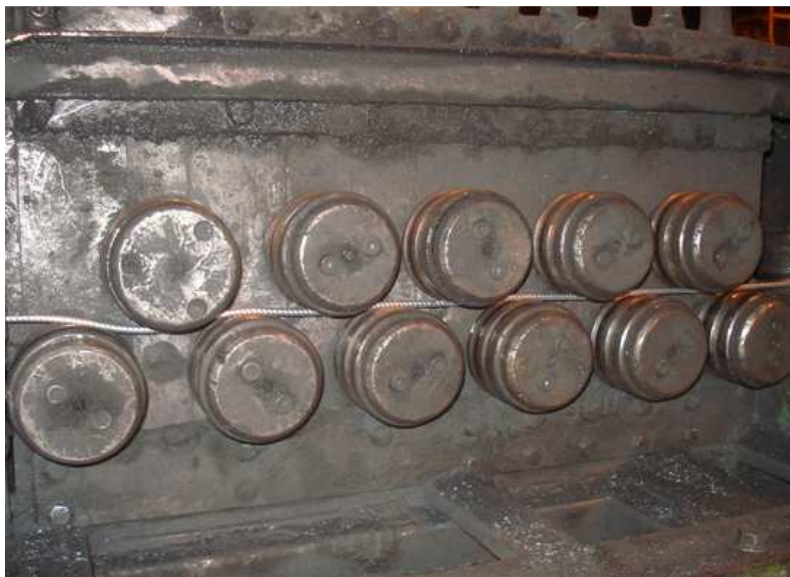
Figura 2.12 Endireitamento por roletes Fonte: Cortesia de usina siderúrgica.
