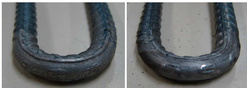
Figura 4.15 Amostras de vergalhão reto após ensaio de dobramento a 180° na bitola 6,3mm
