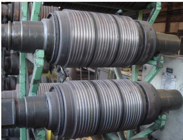
Figura 2.11 Cilindros de laminação com canais usinados Fonte: Cortesia de usina siderúrgica.
