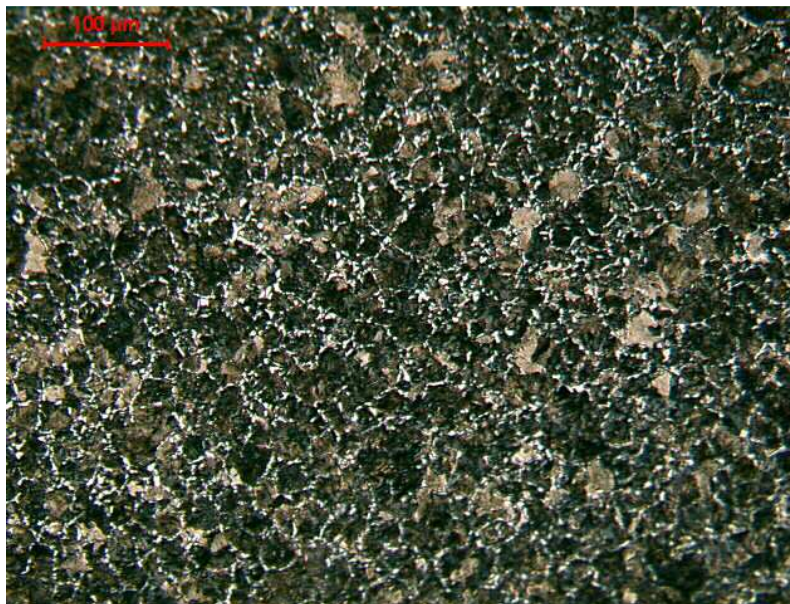
Figura 4.6 Microestrutura da secção transversal de uma amostra de vergalhão 8,0 mm na composição sem modificações, revelada a partir de ataque Nital 2% e com aumento de 200X
