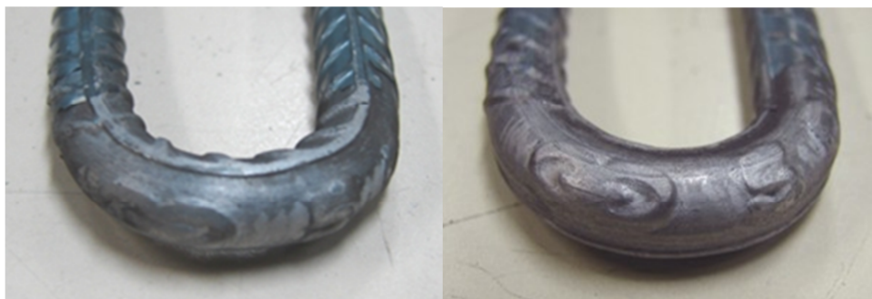
Figura 4.12 Amostras de vergalhão em rolo após ensaio de dobramento a 180° na bitola 8,0 mm
