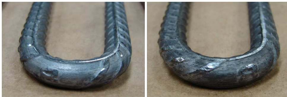
Figura 4.14 Resultados dos ensaios de dobramento a 180° nas amostras de vergalhão em rolo na bitola 8,0mm
