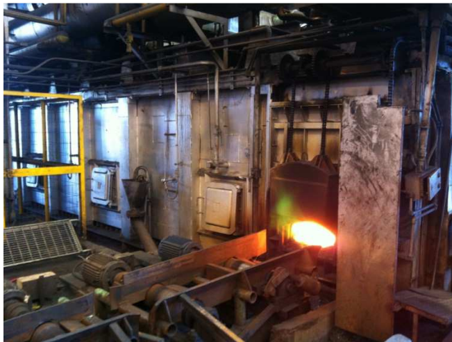
Figura 2.10 Forno de reaquecimento Fonte: Cortesia de usina siderúrgica.
