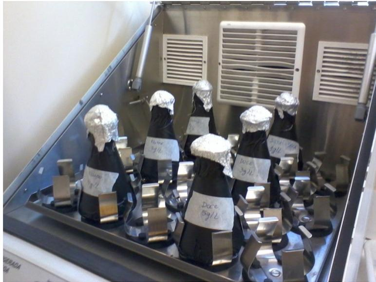
Figura 2 – Frascos no interior da incubadora shaker para o teste preliminar de cultivo heterotrófico
