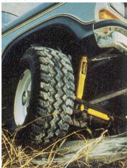
Para amortiguar las oscilaciones de esta camioneta se utilizan los amortiguadores (cilindros amarillos) que absorben los choques.
