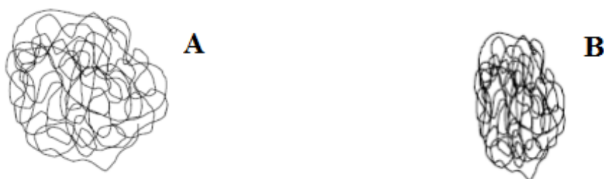
Figura 22: Esquemática do polímero em um bom solvente (A) e em mal solvente (B).
