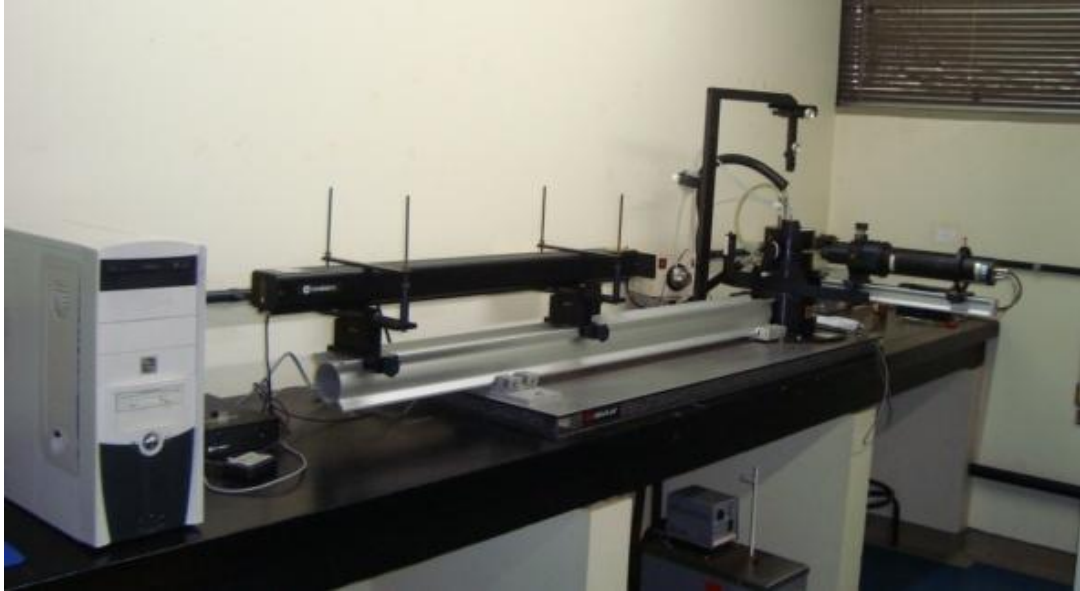
Figura 18: Equipamento Brookhaven utilizado nas medidas de espalhamento de luz estático e dinâmico.
