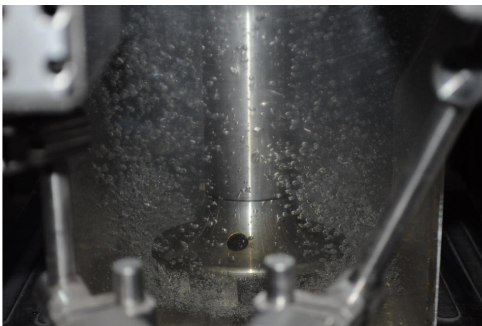
Figura 86. Geração de bolhas dentro da célula de flotação. Fonte: Autoria própria, (2013) – LAPROM/UFRGS
