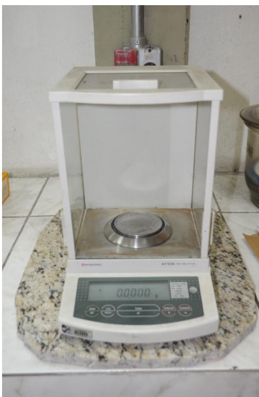
Figura 84. Balança analítica SHIMADZU AY220, C. Máx. 220g, C mín. 0,01 g. Fonte: Aatoria própria, (2013) – LAPROM/UFRGS
