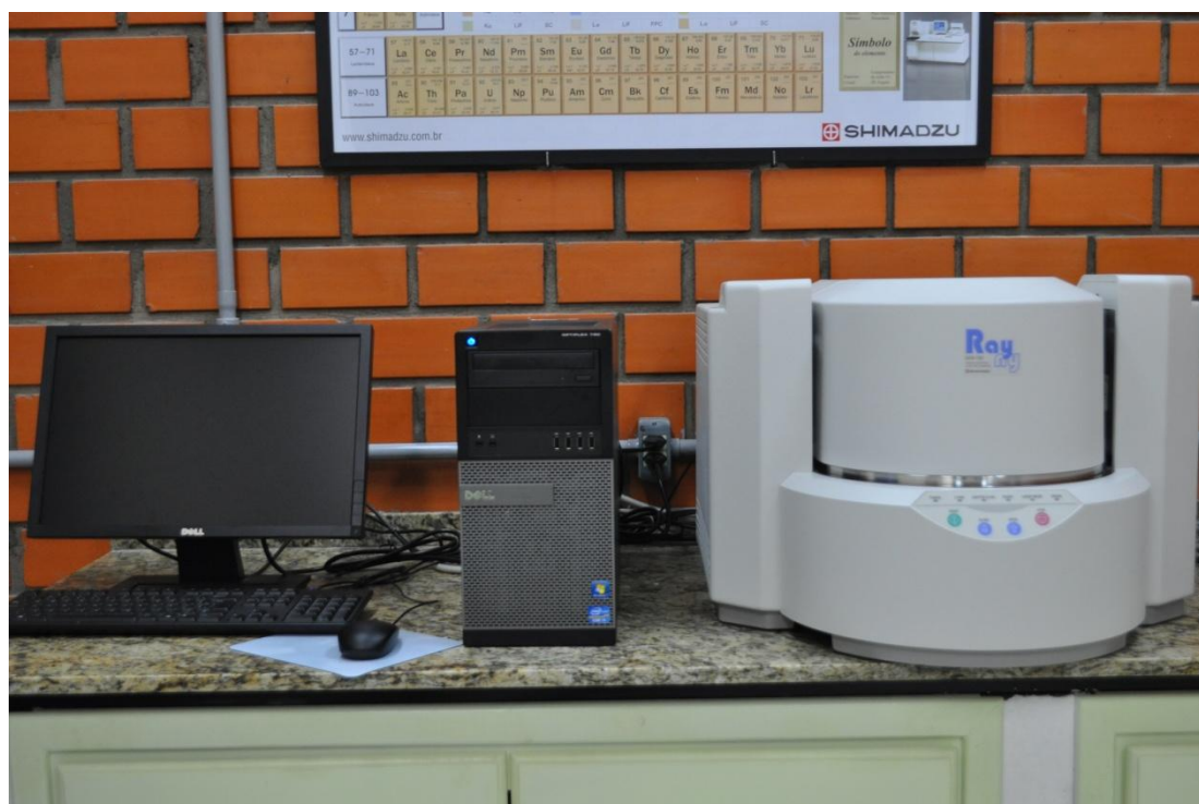
Figura 91. Espectrômetro de raios-X RAY NY EDX-720 SHIMADZU. Fonte: Autoria própria, (2013) – LAPROM/UFRGS
