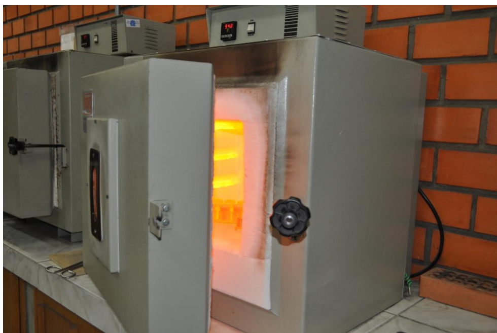
Figura 85. Forno Mufla Jung, modelo 5463. Fonte: Aatoria própria, (2013) – LAPROM/UFRGS
