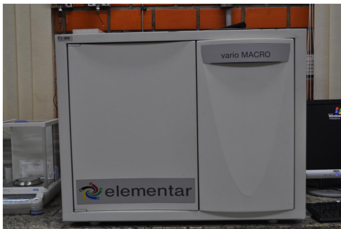
Figura 90. Equipamento para análises elementar CHSNO. Fonte: Autoria própria, (2013) – LAPROM/UFRGS
