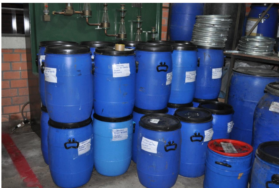
Figura 82. Amostras de polpa do “lodo” de rejeito da Carbonífera Criciúma, devidamente acondicionadas em toneis de 50 litros, listas para seu armazenamento. Fonte: Autoria própria, (2013) – LAPROM/UFRGS
