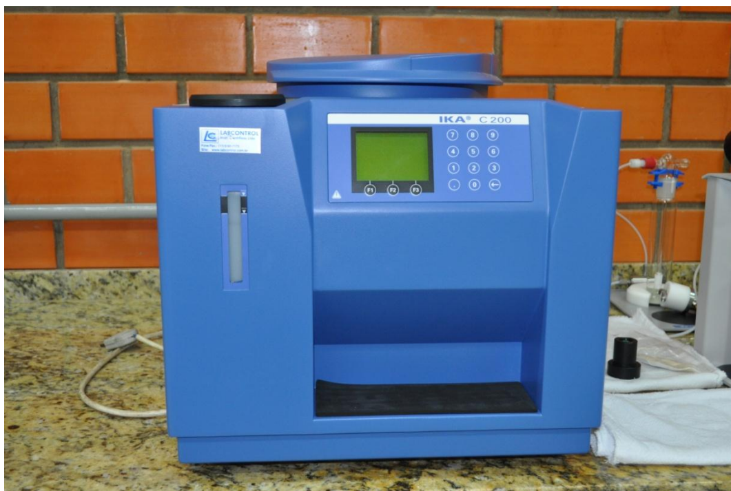
Figura 89. Bomba calorimétrica. Fonte: Autoria própria, (2013) – LAPROM/UFRGS
