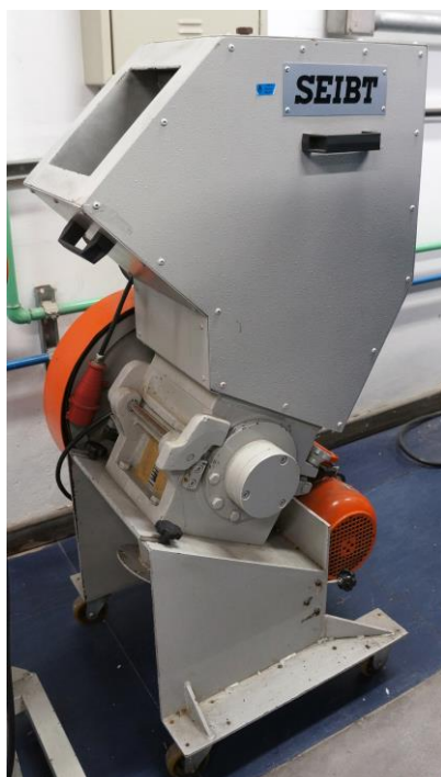
Figura 12 – Moinho de facas rotativas do LPA/IQ/UFRGS
