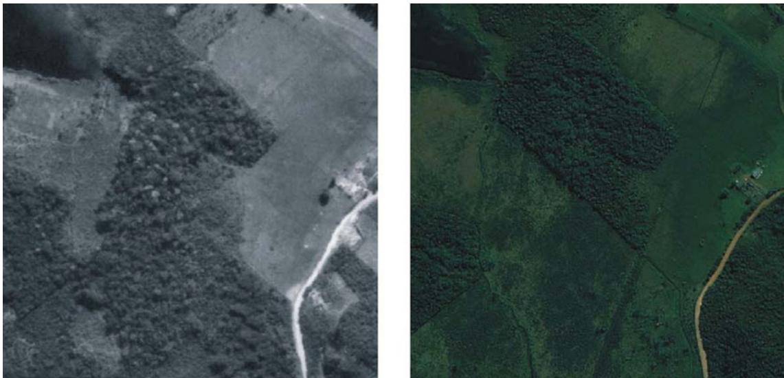
Figura 10. Comparação do mosaico de fotografias aéreas (esquerda) com a imagem Quickbird (direita). Ambas foram interpretadas por vetorização em tela na escala 1: 2.000.
