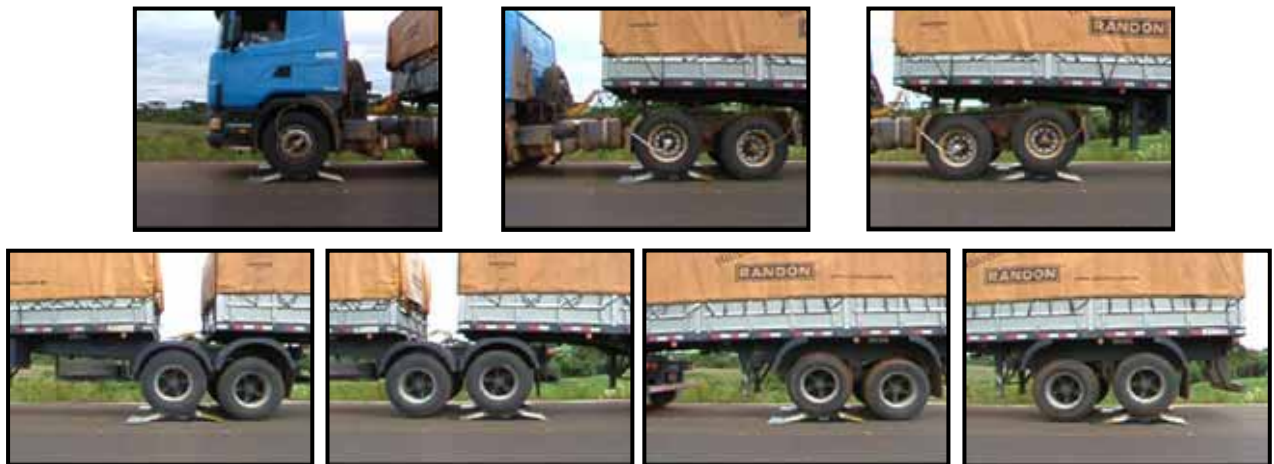
Figura 4.8 – Passagem de cada eixo do veículo pelas rampas.
