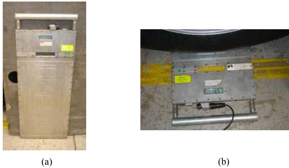
Figura 4.4 – Balança utilizada na medição de cada rodado; (a) fora do produto; (b) medindo um rodado.
