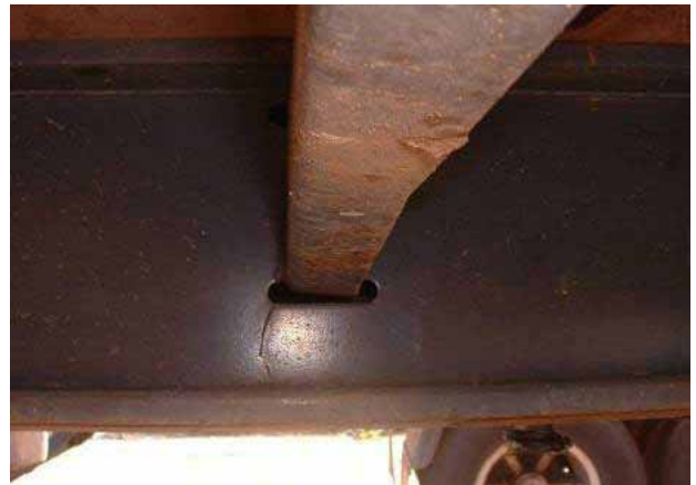
Figura 5.10 – Trincas ocorridas em serviço na alma da longarina (ponto 1).
