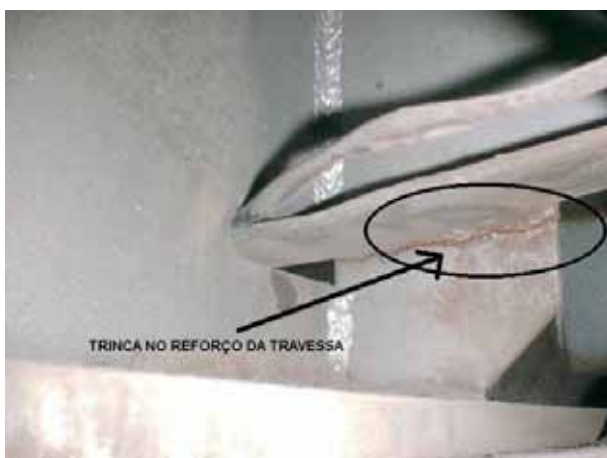
Figura 5.12 – Trincas ocorridas em serviço no reforço da travessa próximo ao acoplamento (ponto 3).
