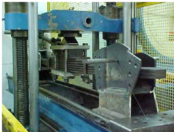
Figura 3.4 – Medição do feixe de mola.
