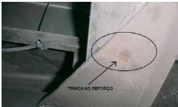
Figura 5.11 – Trincas ocorridas em serviço no reforço da aba inferior da longarina (ponto 2).
