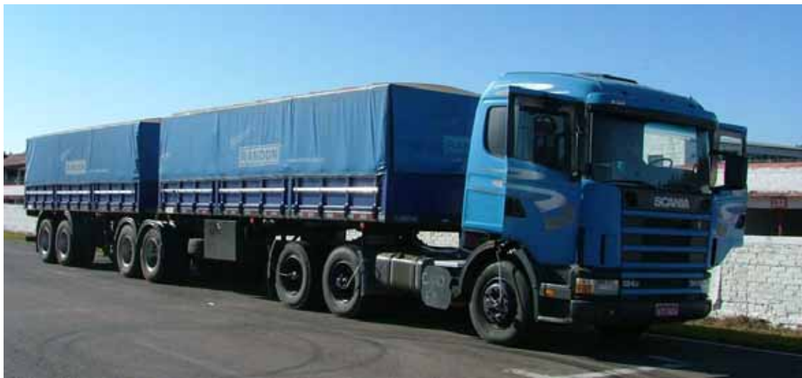
Figura 1.1 – Combinação veicular do tipo bitrem empregada no presente trabalho.
