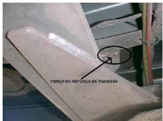
Figura 5.12 – Trincas ocorridas em serviço no reforço da travessa próximo ao acoplamento (ponto 3).
