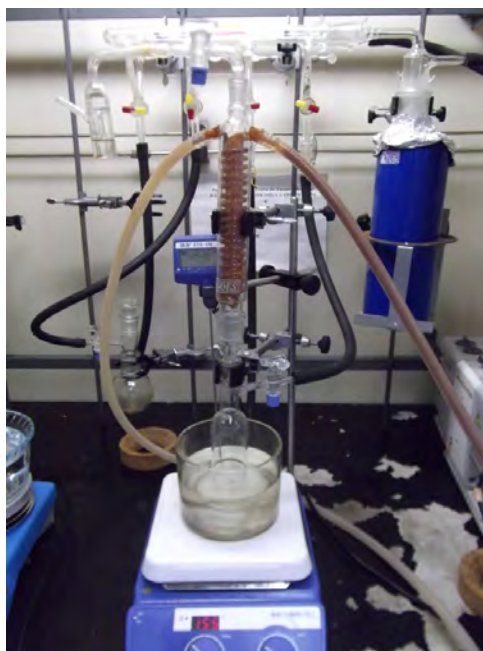
Figura 9 - Sistema usado para as reações de isomerização/metátese em tandem.
