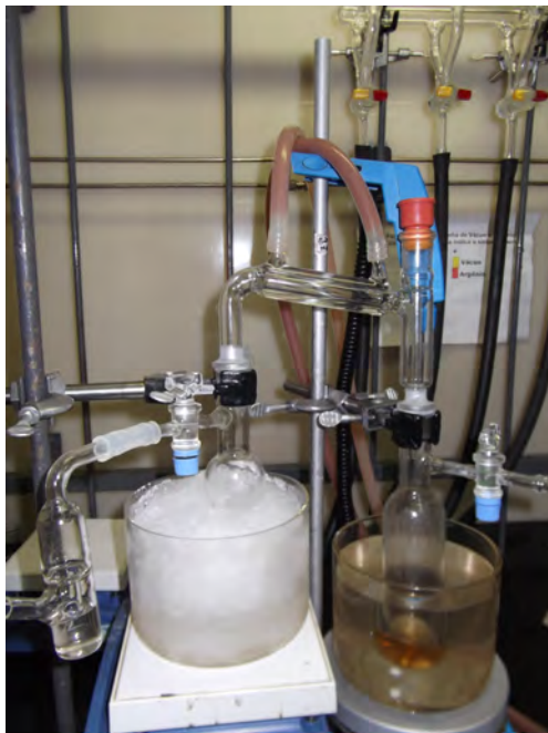
Figura 10 - Sistema usado para captura dos produtos voláteis formados durante as reações de isomerização/metátese em tandem.
