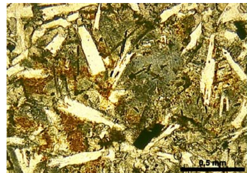
Amostra 33 – ampliação 5x, luz natural – basalto
