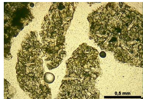
Amostra 24 – ampliação 5x, luz natural – basalto
