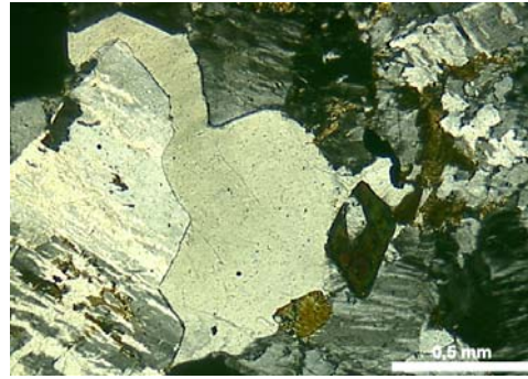
Amostra 14 – ampliação 5x, luz polarizada – granito
