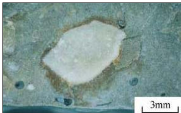
Figura 2.5: imagens dos produtos oriundos da reação álcali-carbonato, obtidas através de microscopia eletrônica de varredura por elétrons retroespalhados - início da redução do volume sólido
