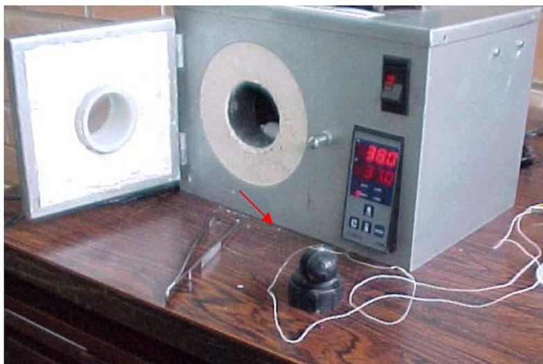
Figura 6.2. Modelo físico para o olho humano. Os fios brancos levavam o sinal do sensor NTC para um multíteste quando este se encontrava dentro do forno, com a porta fechada (foto do autor).
