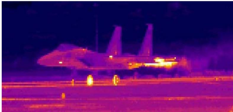
Figura 4.6 Localização noturna de aeronaves. No termograma, um avião militar decolando, sendo possível observar o aquecimento, por atrito, dos pneus contra o solo (VERATTI, VERATTI e PUGNO, 1997).
