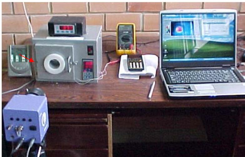
Figura 6.4 Aparato para medições e cálculo de emissividade. O termógrafo focalizava o alvo através da janela infravermelha identificada pela seta, de uma distância de 40 centímetros (foto do autor).
