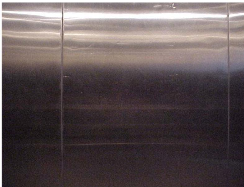
Figura 3.2 Imagem de uma parede em aço escovado, no espectro visível. A parede estava fartamente iluminada e esperava-se ver refletida a imagem do operador da câmera fotográfica.
