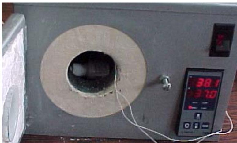
Figura 6.3 Posicionamento do modelo físico para medições. O frasco de colírio, para umidificação das córneas, também era guardado dentro do forno para manter modelo e colírio na mesma temperatura (foto do autor).
