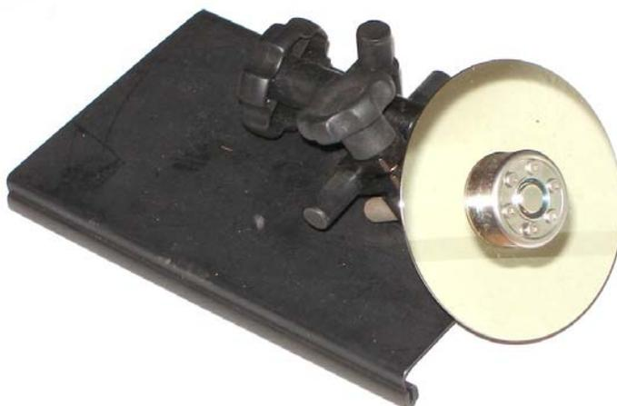
Figura 6.6 Sistema para fixação do espelho plano, empregado para refletir a imagem do olho direito de paciente de cirurgia (foto do autor).
