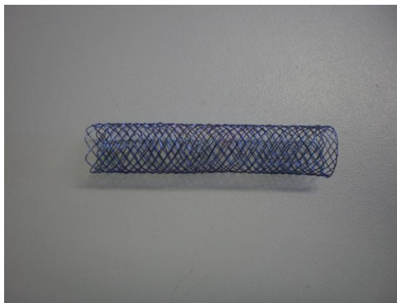
Figura 12. Stent de NiTi para aplicação em vias aéreas produzido no LdTM.
