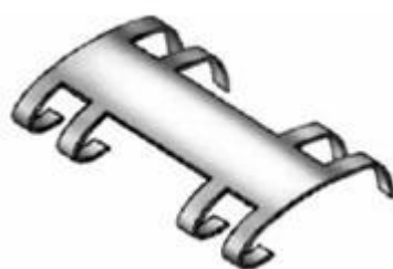
Figura 14. Grampo de Judet para estabilização de ossos de costelas fraturadas desenvolvido no LdTM.
