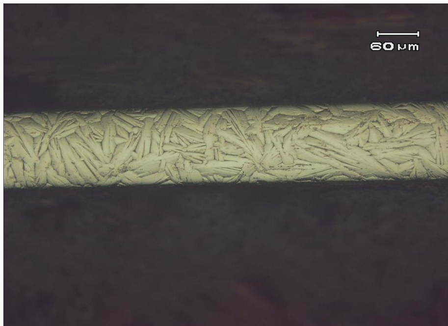
Figura 43. Metalografia da amostra 3 do fio de NiTi com tratamento térmico de 570° C.
