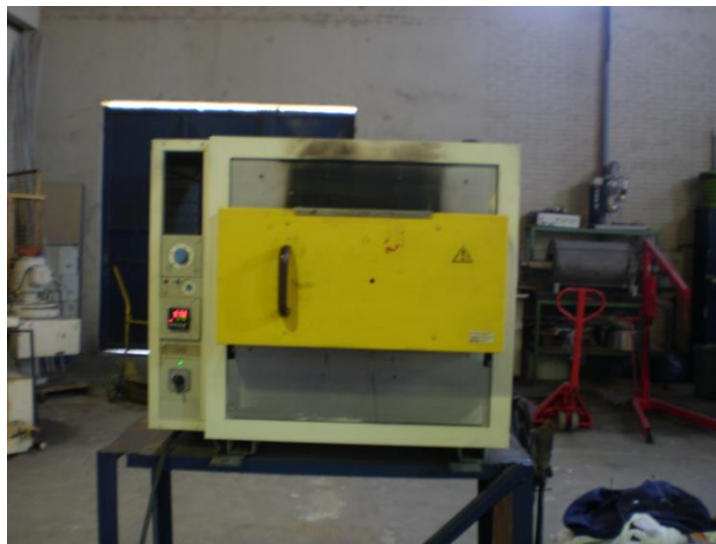
Figura 23. Forno utilizado para o tratamento térmicos dos fios e chapas de NiTi.
