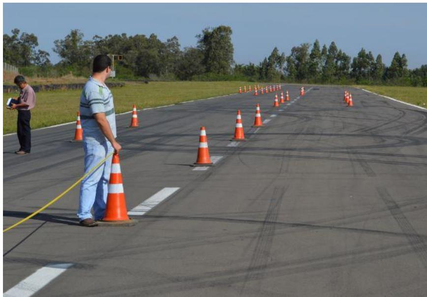
Figura A.10 Montagem da pista de DLC
