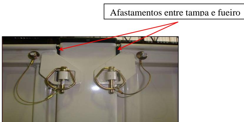
Figura 3.12 Afastamento lateral entre as tampas e o fueiro, na caixa de carga
