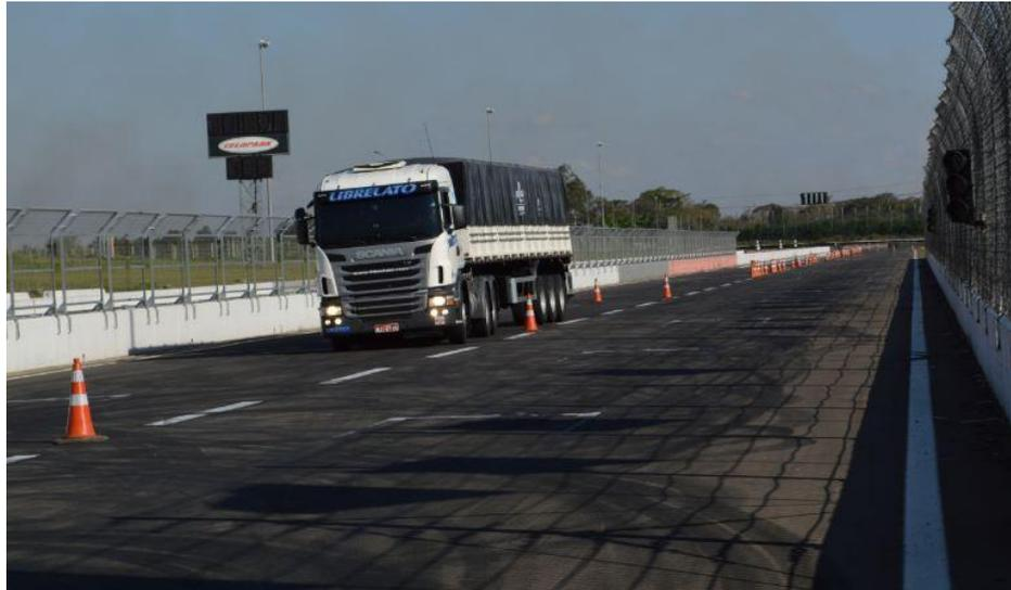
Figura A.9 Imagem da manobra de *slalom* a 40 km/h
