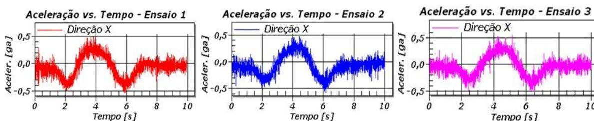
Figura 6.16 Aceleração lateral no domínio do tempo - 70 km/h
