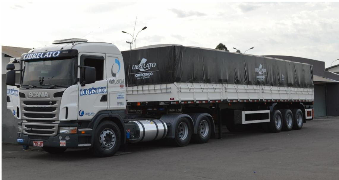
Figura 3.4 Semirreboque graneleiro de comprimento 12.400 mm
