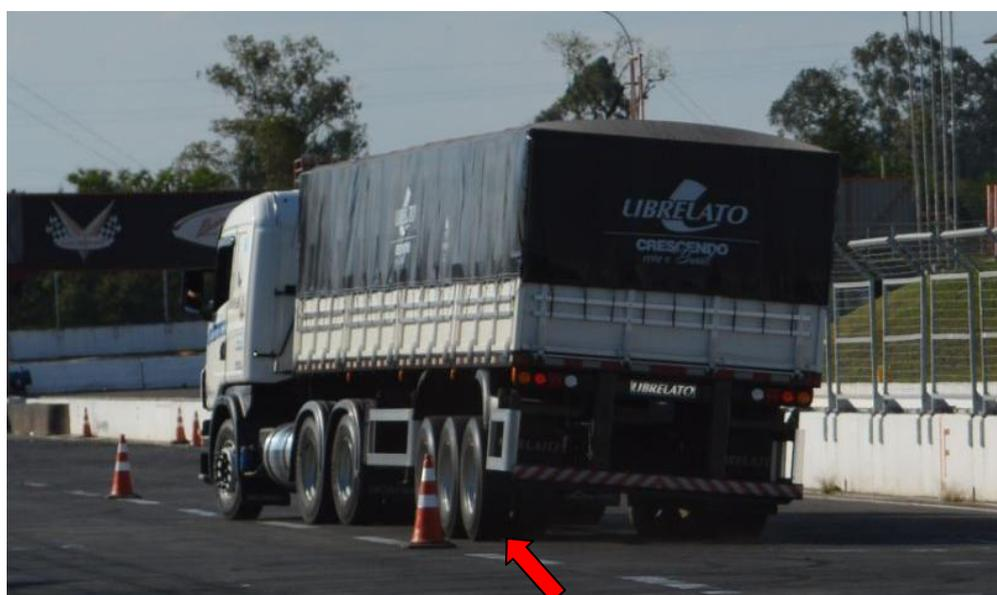
Figura 6.11 Teste de *slalom* a 40 km/h com levantamento do eixo traseiro do semirreboque
