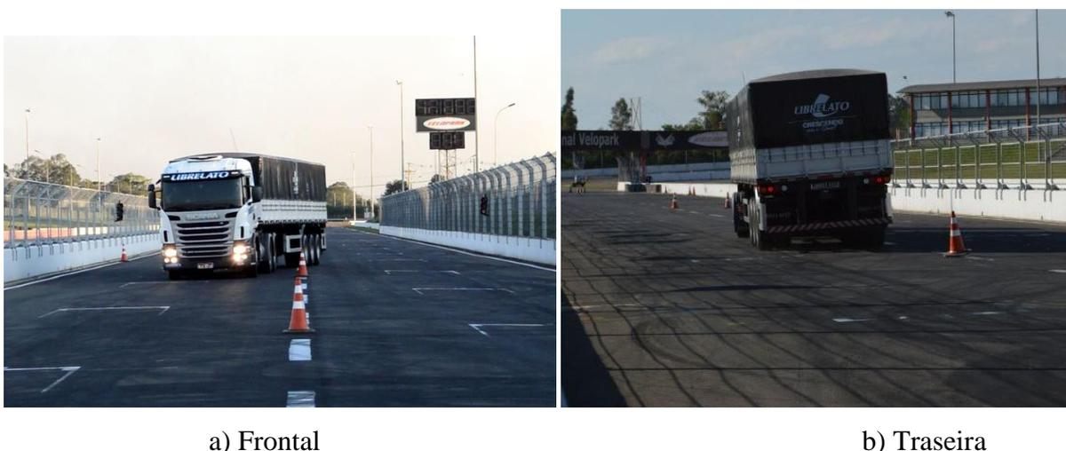
Figura 4.13 Execução do *slalom* a 40 km/h
