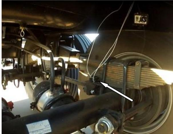
Figura 4.23 Posicionamento dos acelerômetros no eixo
