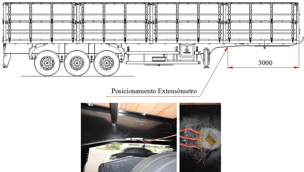
Figura 4.20 Posicionamento do extensômetro no semirreboque
