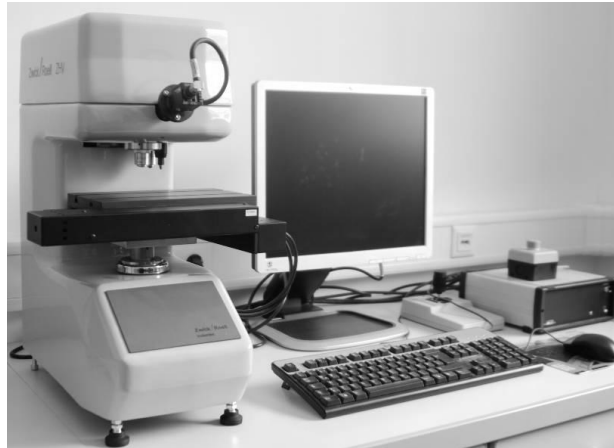
Figura 3. 9 Microdurômetro modelo ZHV1/2 Micro-Vickers.
