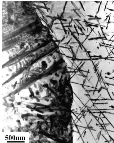
Figura 2. 6 MET micrografia mostrando as regiões de precipitação descontínua (lado esquerdo) e contínua (lado direito) em um amostra de Mg AZ91 envelhecida a 200°C por 4h (CELLOTO 2001).
