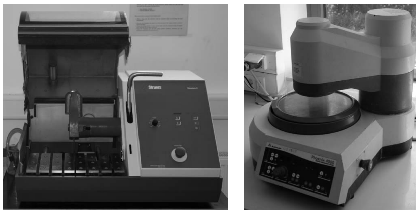
Figura 3. 10 Máquina de corte Struers Discotom-6 e máquina de polimento Buehler Phoenix 4000.
