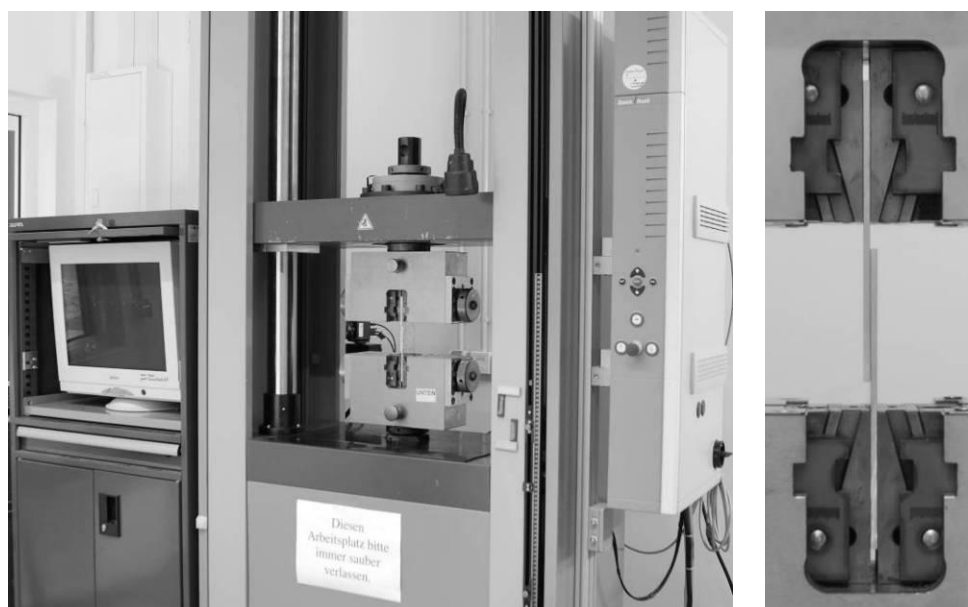
Figura 3. 6 Máquina tipo fuso da Zwick / Roell utilizada para a avaliação da resistência mecânica das juntas soldadas sob solicitação de cisalhamento.
