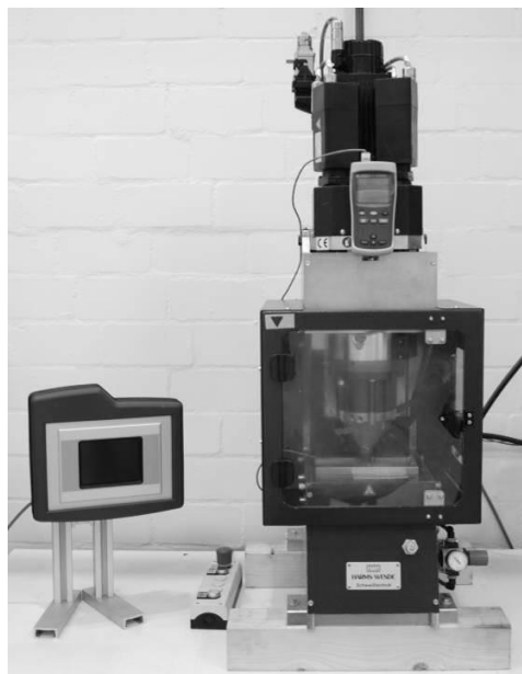
Figura 3. 4 Máquina de soldagem SpF (RPS 100).
