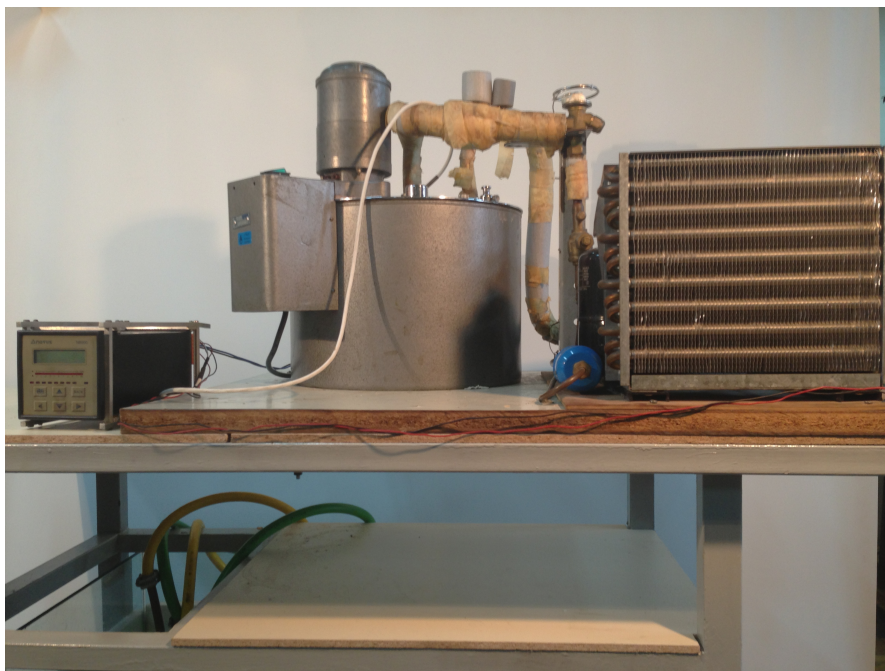
Figura 4.5 – Termoacumulador e sistema de refrigeração industrial.
