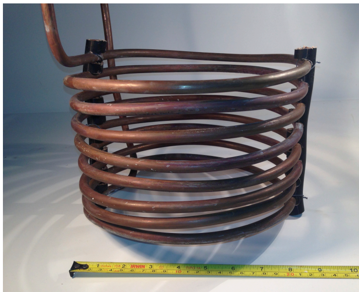
Figura 4.3 – Serpentina de cobre com os espaçadores instalados.
