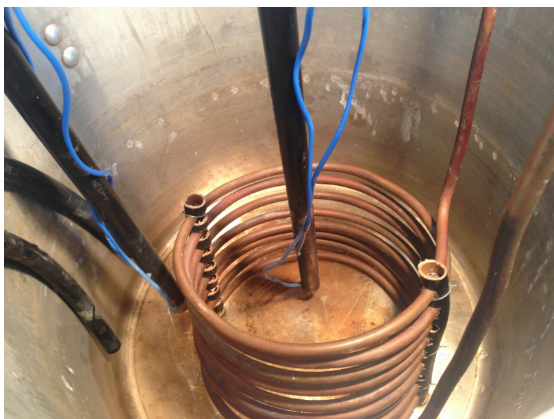
Figura 4.4 – Disposição dos termopares na panela de resfriamento.
