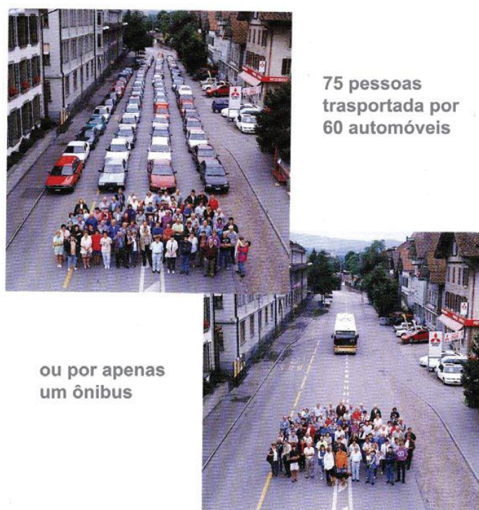
Figura 14 – Comparativo de ocupação de espaço entre um automóvel e um ônibus
