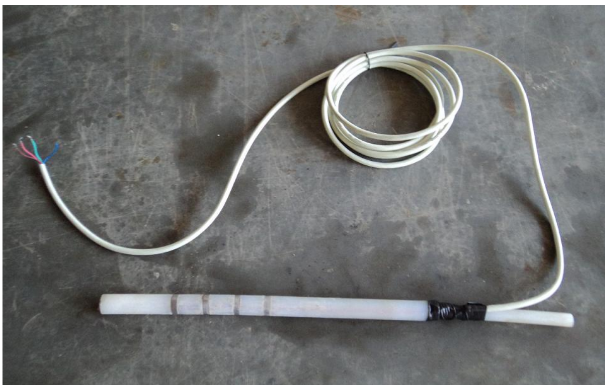
Figura 6 – Equipamento utilizado para ensaios de resistividade elétrica
