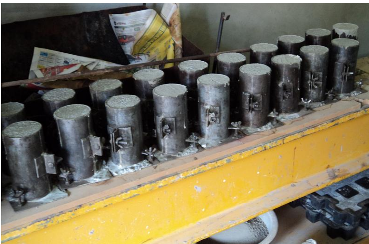
Figura 11 – Corpos de prova metálicos moldados para posterior ensaio à compressão
