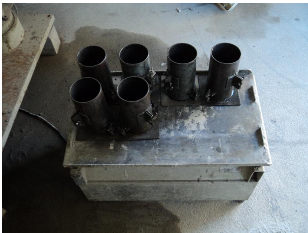
Figura 10 – corpos de prova metálicos colocados sobre a mesa vibratória
