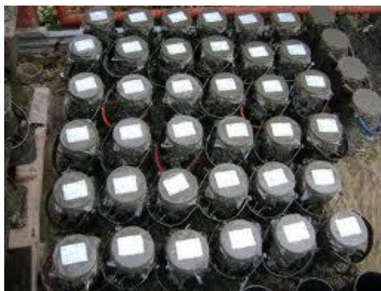
Figura 4 – Corpos de prova para ensaio de resistência à compressão moldados e identificados
