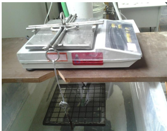
Figura17 – Dispositivo metálico acoplado na balança hidrostática para pesagem dos corpos-de prova úmidos
