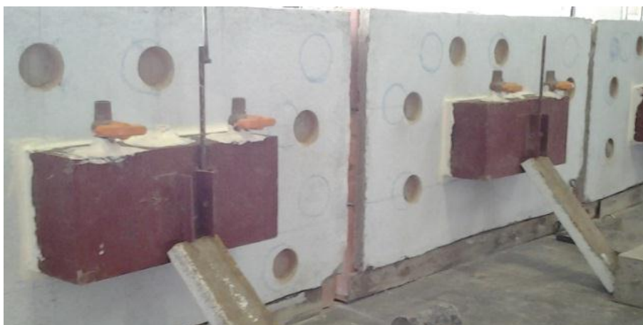
Figura 11 – Caixas do ensaio fixadas nos prismas
