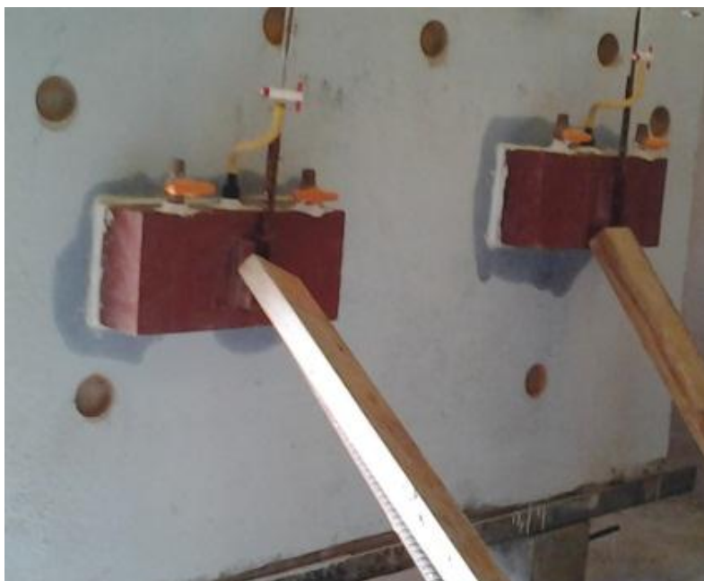
Figura 24 – Mancha de água do sistema de revestimento: prisma grande após 6 horas
