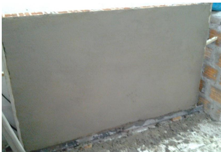
Figura 8 – Prismas de dimensões 1,50x1,00m para realização dos três ensaios
