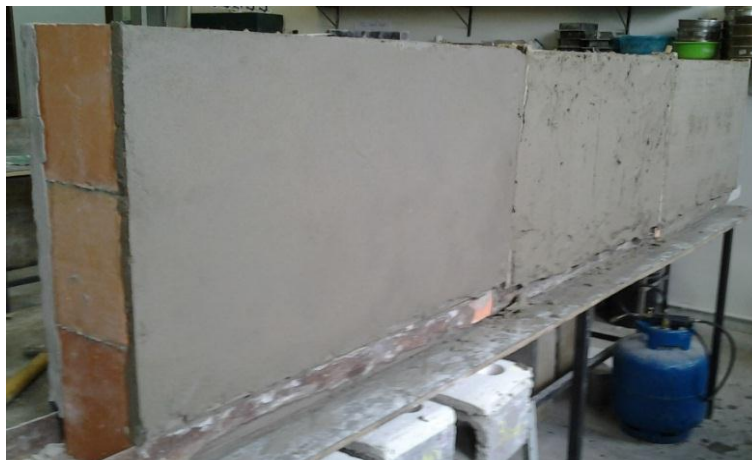
Figura 7 – Prismas de dimensões 0,90x0,60m com argamassa aplicada
