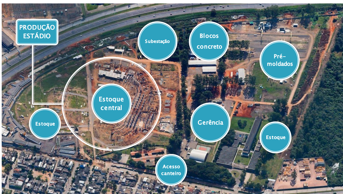
Figura 23 – Layout do canteiro de obras
