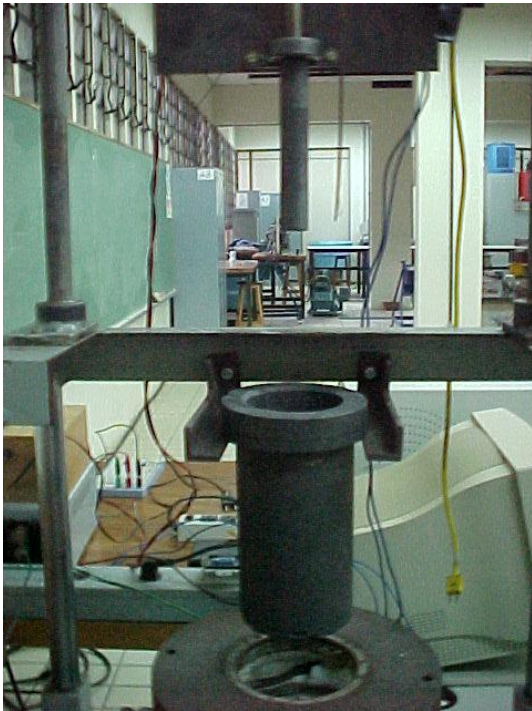
Figura 24 – Solução encontrada para confeccionar o cadinho e a haste
