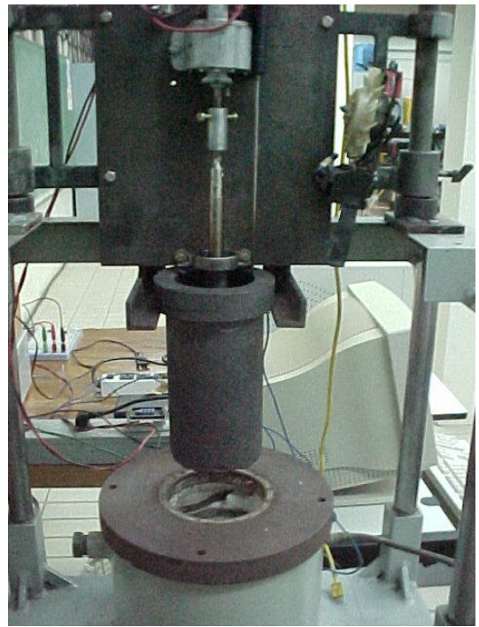
Figura 24 – Solução encontrada para confeccionar o cadinho e a haste
