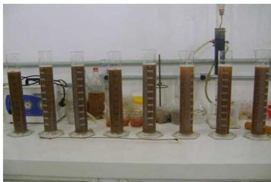
Figura 6. Suspensão de solo para análise granulométrica.
