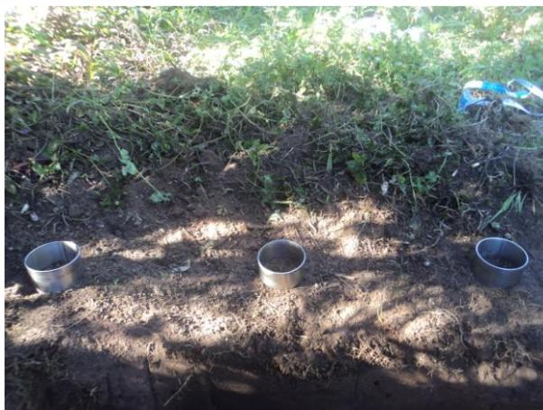
Figura 7. Amostragem do solo, nos pontos de LPC, R e ER com uso de anéis volumétricos para análise física do solo.
