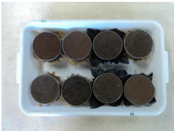
Figura 8. Amostras de solo submetidas à saturação por água para a determinação da porosidade total do solo.
