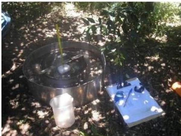
Figura 10. Ensaio de infiltração de água no solo com uso de infiltrômetro de cilindros concêntricos.
