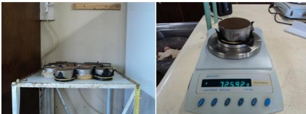
Figura 9. Uso de mesa de tensão e determinação da massa do solo para a determinação da porosidade e densidade do solo.
