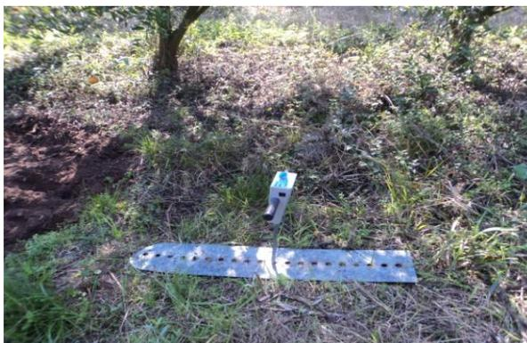
Figura 11. Penetrômetro digital utilizado para análise de resistência mecânica do solo à penetração nas entrelinhas de plantio do pomar orgânico.
