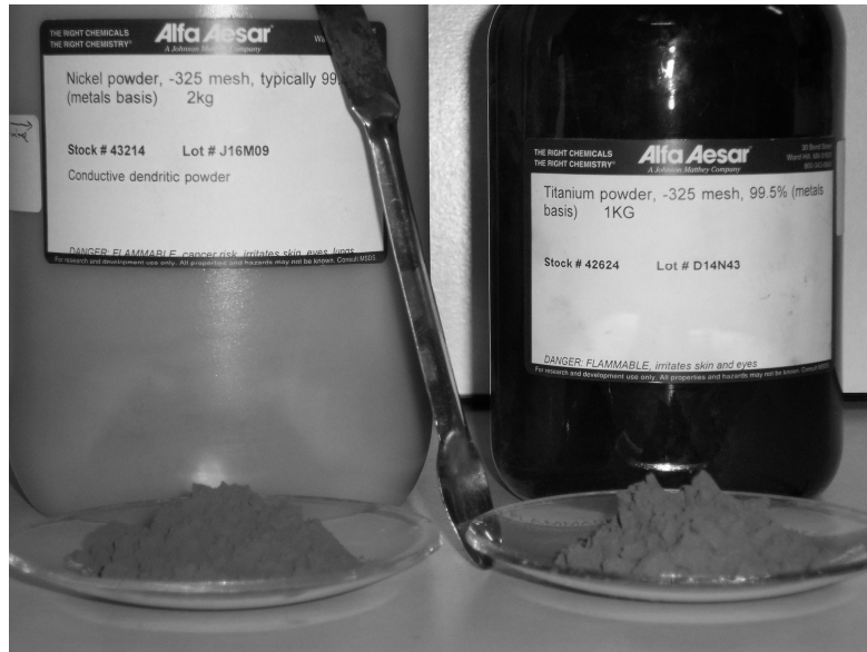
Figura 3.4 – Pós de níquel e titânio utilizados para a compactação dos billets de Nitinol.
