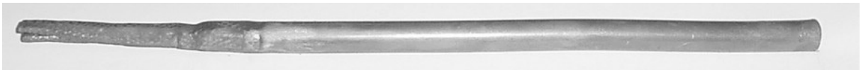
Figura 6.2 – Tubo de cobre comercial com a mistura de pós de Ni e Ti pré-compactado em seu interior.
