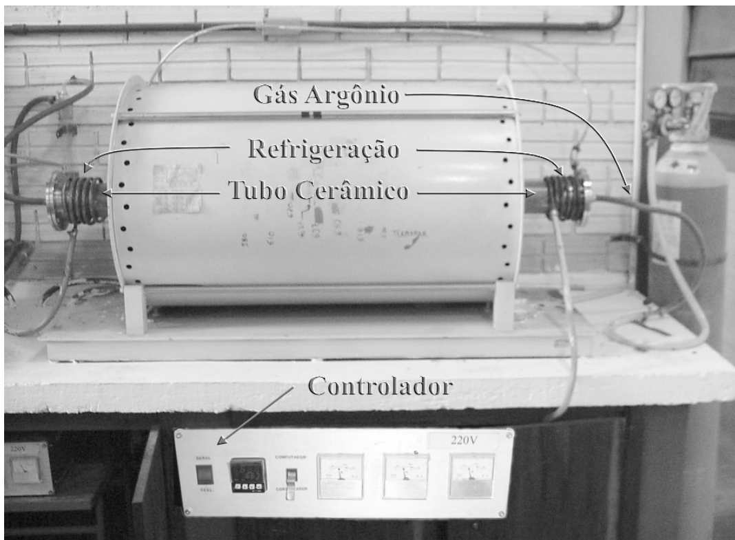
Figura 3.8 – Forno de sinterização fabricado no LdTM/UFRGS.
